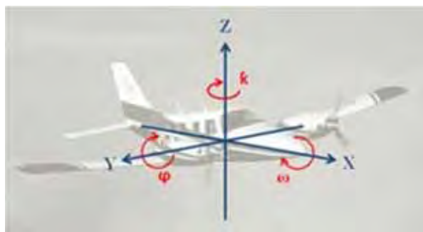
Figura 1. Ângulos de atitude ( \omega – em torno do eixo x; \varphi – em torno do eixo y; \kappa – em torno do eixo z) da aeronave. Adaptado de Brito e Coelho (2002).
