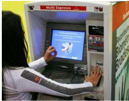
Figura 3: Caixa eletrônico do banco Bradesco, equipado com leitor da palma da mão. Fonte: extraído da referência (FOLHAONLINE, 2007).
