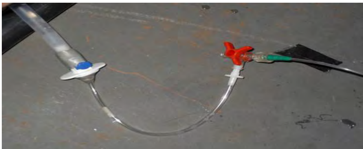
Figura 10 – Adaptação para uso de “Scalp” intravenoso nas tubulações.
