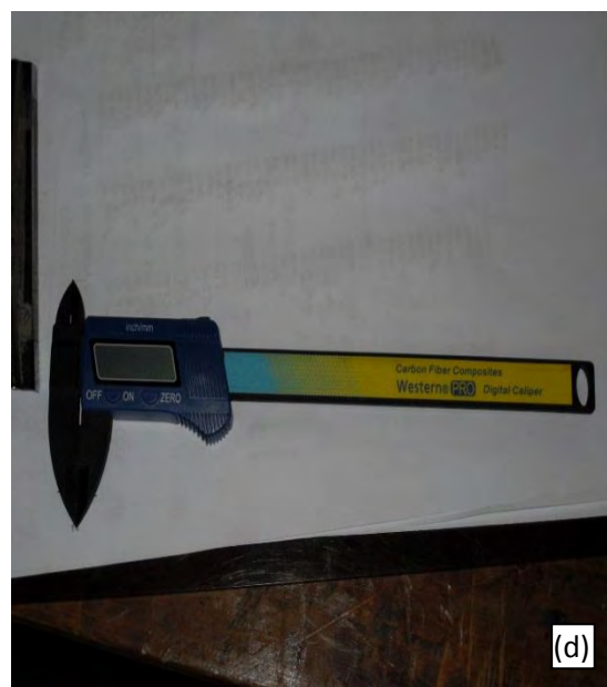
Figura 4 – Equipamentos de medição utilizados no experimento: (a) Medidor de vazão utilizado; (b) Sensor de vazão; (c) Manômetro digital utilizado; (d) Paquímetro digital utilizado.
