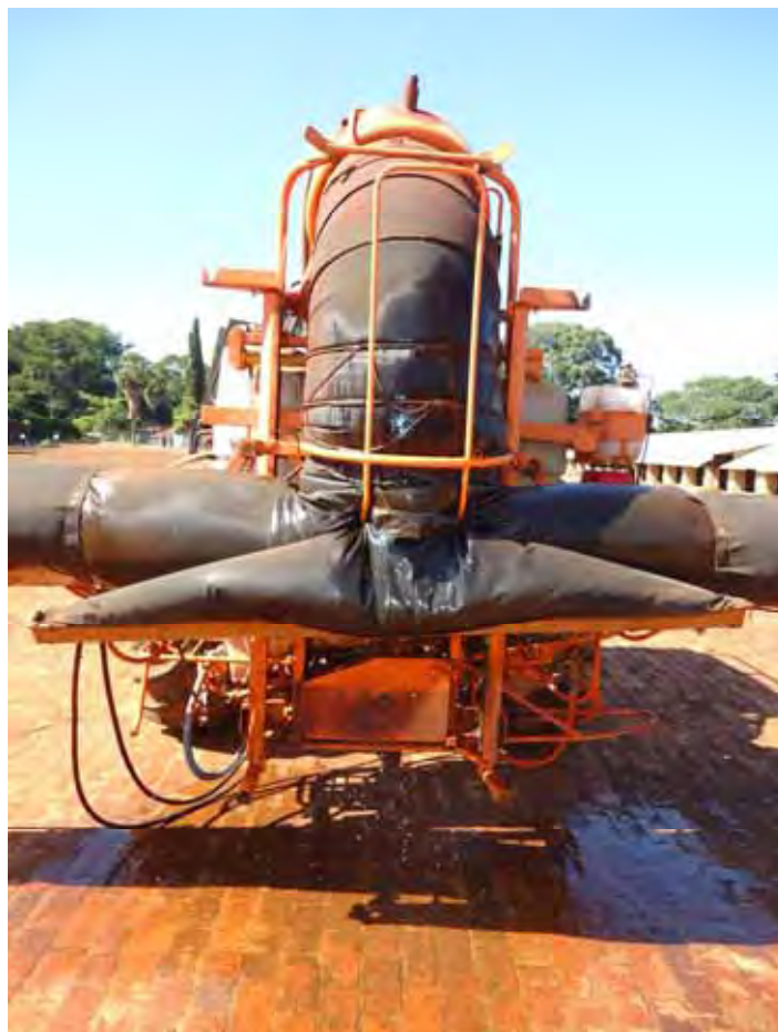
Figura 17. Molhamento e escorrimento causado pela umidificação do fluxo de ar.
