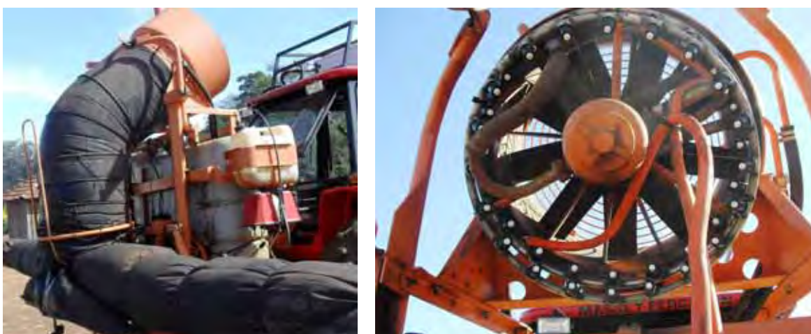
Figura 10. Ramal umidificador da fase exploratória montado no fluxo do ar
