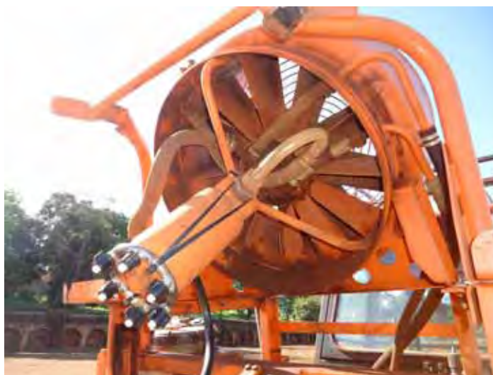
Figura 11. Ramal umidificador da fase definitiva montado no fluxo de ar
