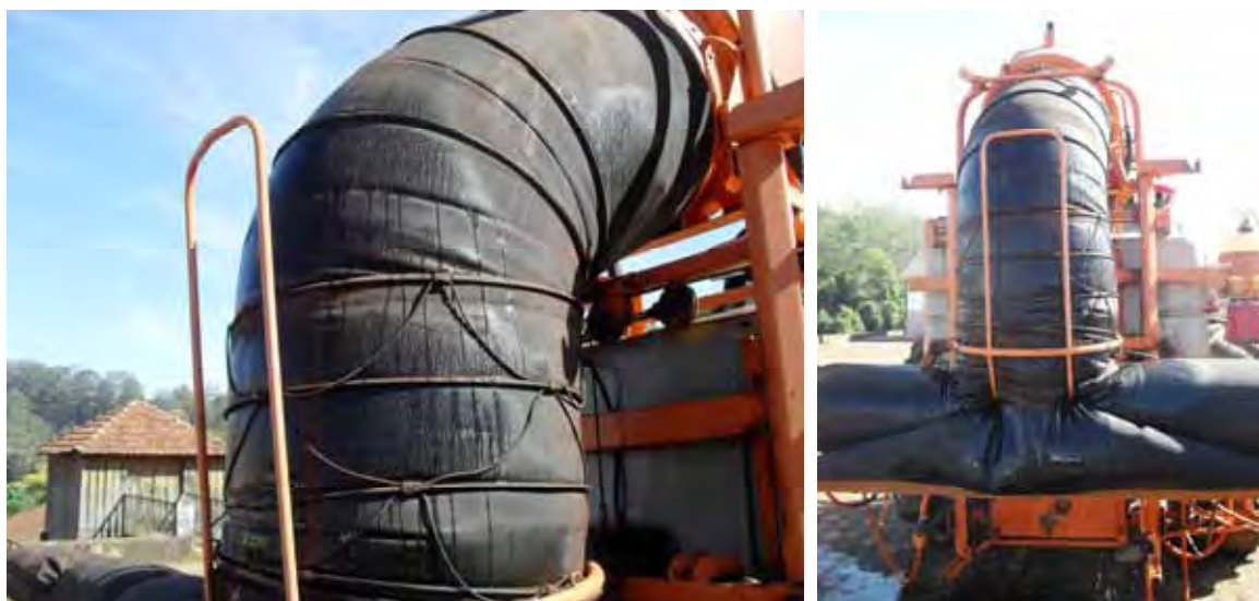
Figura 12. Molhamento e escorrimento no duto de ar central na fase exploratória da pesquisa.
