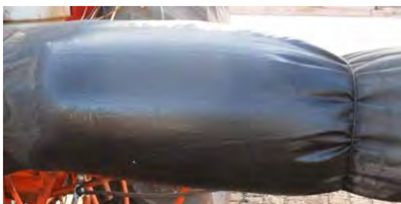
Figura 13. Molhamento e escorrimento no início do duto de ar da barra direita.
