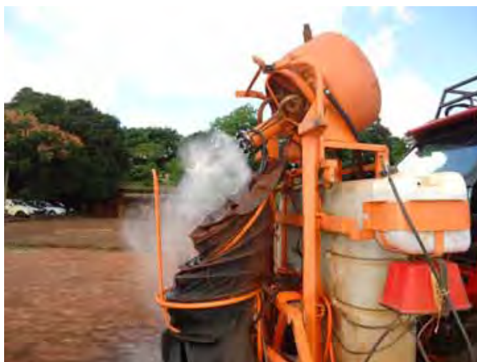
Figura 15. Umidificação com o ventilador desligado e duto de ar desmontado
