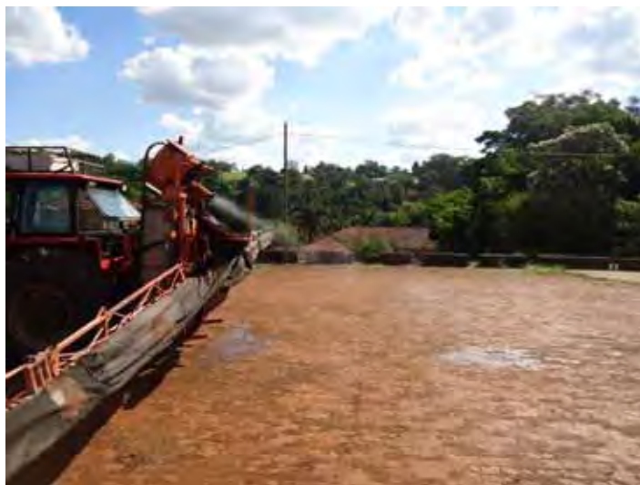
Figura 16. Umidificação com ventilador ligado e duto de ar desmontado
