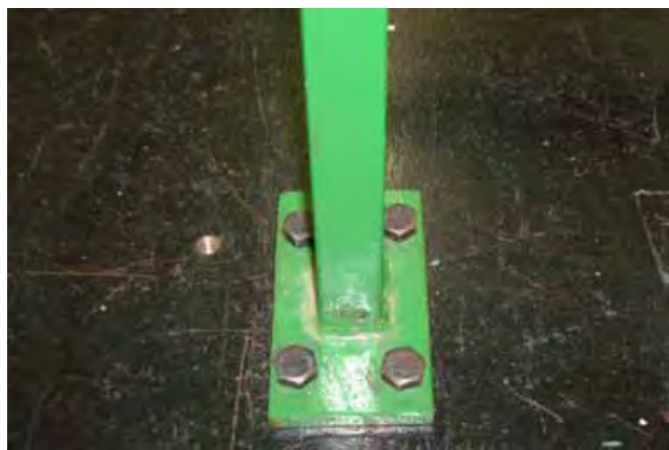
Figura 6.4 – Condição de engaste da estrutura
