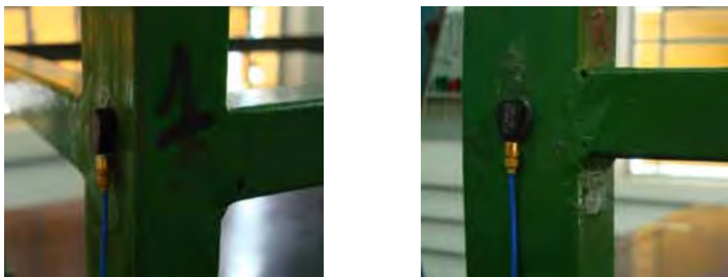
Figura 6.6 – Detalhes da fixação do acelerômetro no frame
