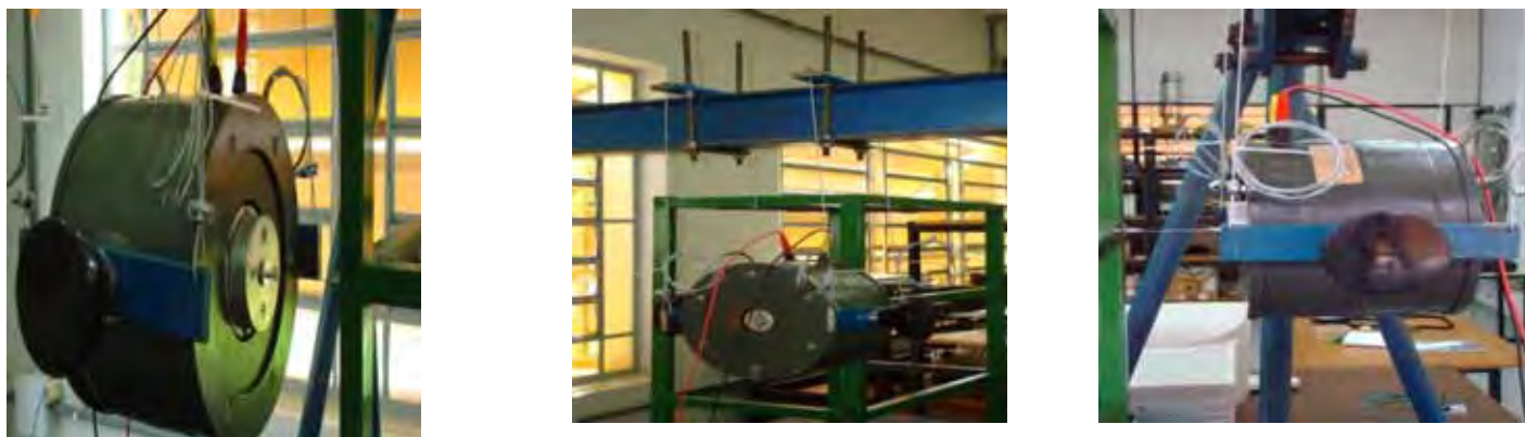
Figura 6.5 Detalhes da excitação da estrutura utilizando o shaker
