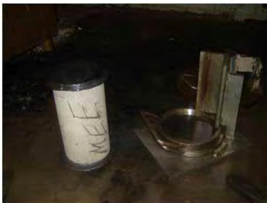
Figura 37- Corpo-de-prova capeado com enxofre.
