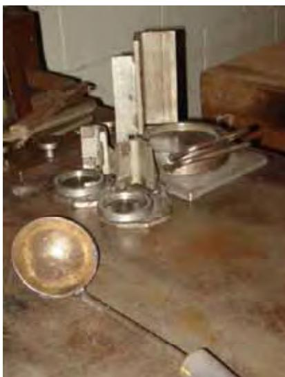
Figura 29- Instrumentos para capeamento.
