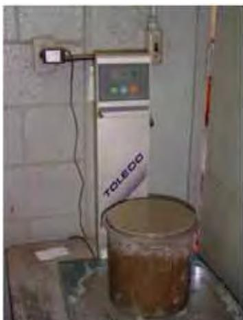
Figura 36- Determinação da Massa Específica.
