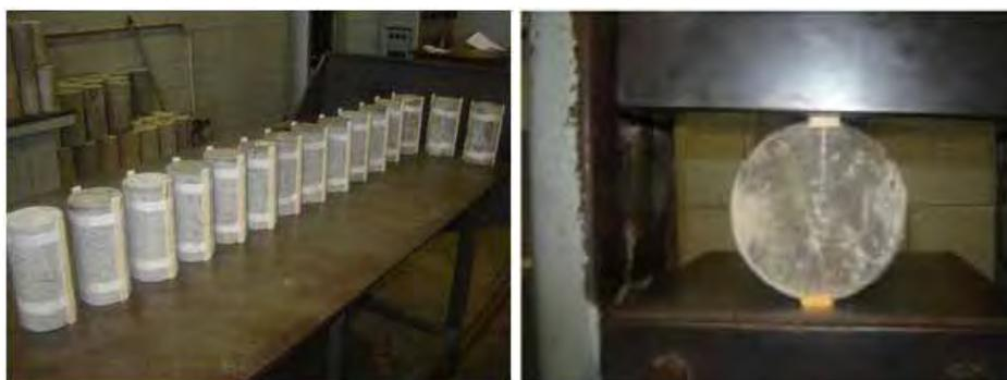
Figura 40- Execução do ensaio à tração por compressão diametral.
