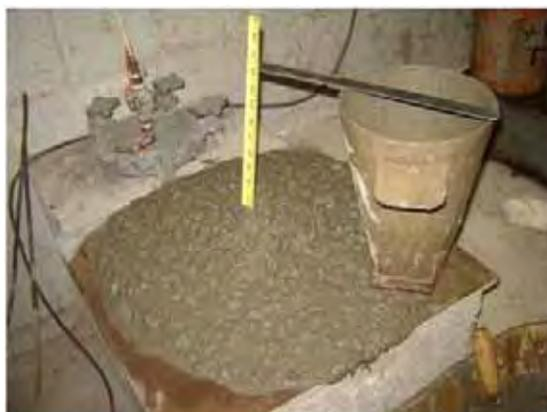
Figura 34- Abatimento do Tronco de Cone.
