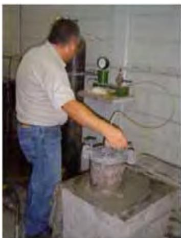
Figura 35- Medidor de Ar.
