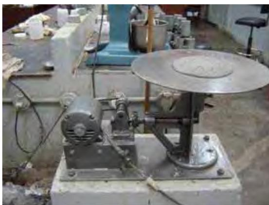
Figura 27- Mesa do aparelho de consistência.
