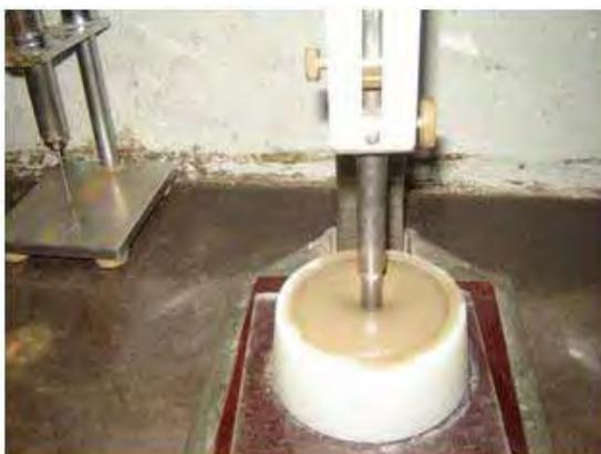
Figura 23- Determinação da quantidade de água.
