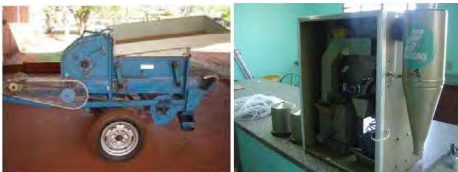
Figura 18- Máquina de trilhagem e Máquina de beneficiamento de arroz.
