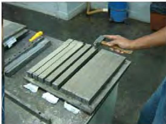
Figura 31- Desmoldagem dos corpos-de-prova.
