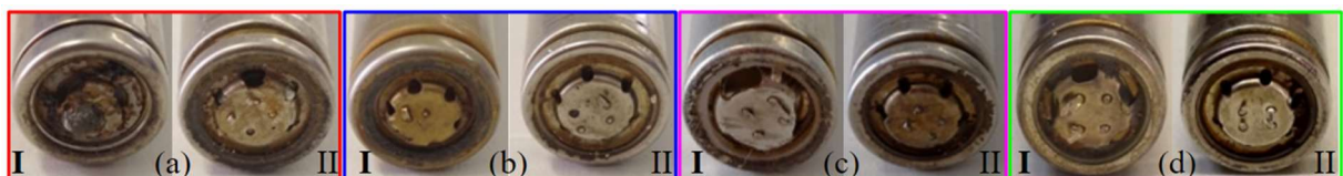
Figura 15 – Terminais das baterias submetidas ao experimento com 0,5 mol/L de \text{FeSO}_4 \cdot 7\text{H}_2\text{O} : (a) Agitação (em vermelho), (b) Todos os fatores (em azul), (c) Metal de sacrifício (em magenta) e (d) Recirculação (em verde).
