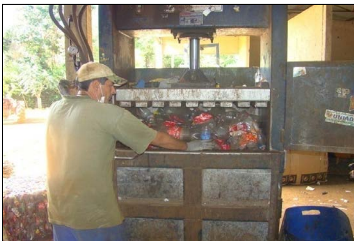
Fotografia 34 - Trabalhador operando a prensa mecânica. Fonte: Do autor (2012).
