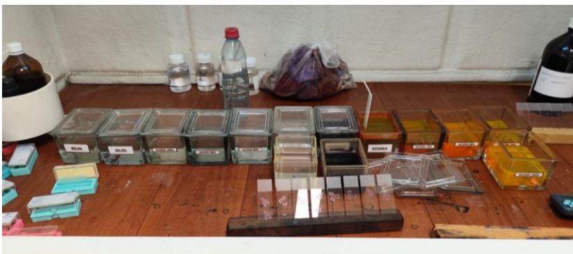
Figura 14. Preparo para coloração de lâminas, com a sequência de submersão em xilol, álcool 100%, álcool 96%, álcool 80%, álcool 70%, água destilada, hematoxilina, bicarbonato, eosina e banhos de álcool 70%, 80%, 90% e 100%. Fonte: arquivo pessoal.
