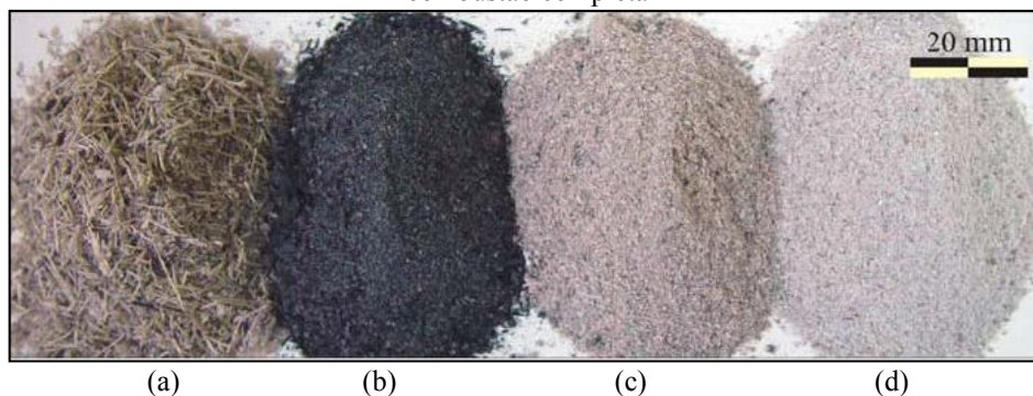
Figura 3.1 - Bagaço de cana-de-açúcar e cinzas: (a) Bagaço de cana. (b) Cinza escura com alto teor de carbono, característico de combustão incompleta. (c) Cinza com menor teor de carbono. (d) Cinza gerada após a combustão completa
