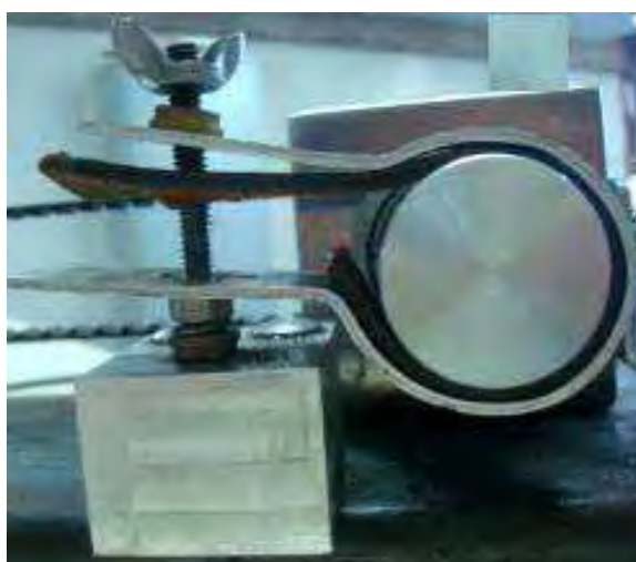
Figura 52: Carga mecânica constante acoplada na saída do conjunto motoredutor.
