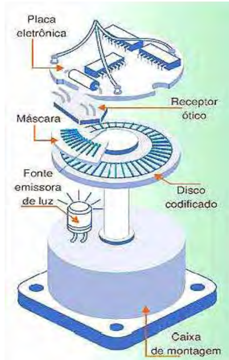
Figura 34: Aspectos físicos de encoders rotativos.
