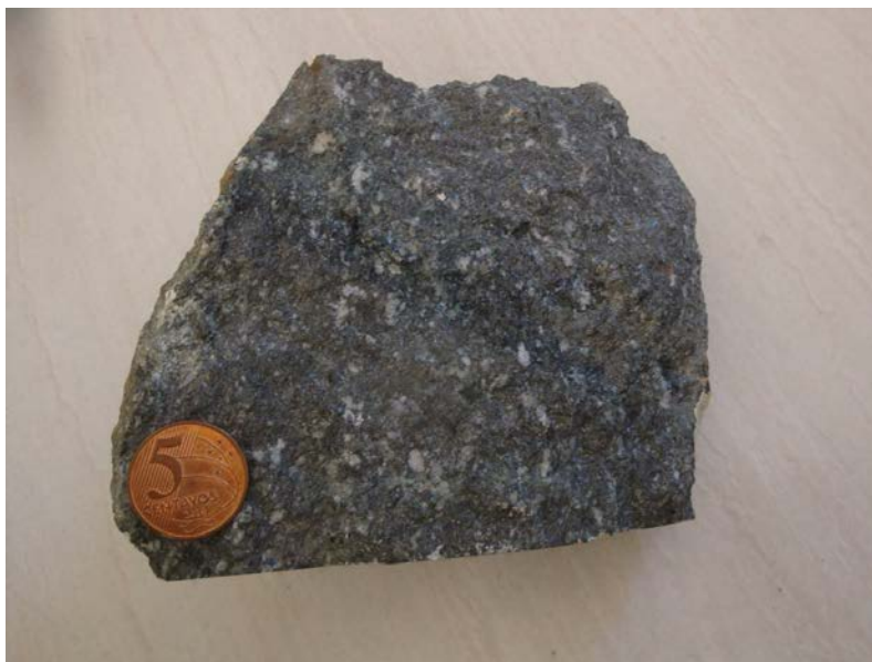
Figura 3.4 Fotografia de anfibolito de coloração verde escuro a preto com pontuações ou manchas esbranquiçadas relativas ao plagioclásio.
