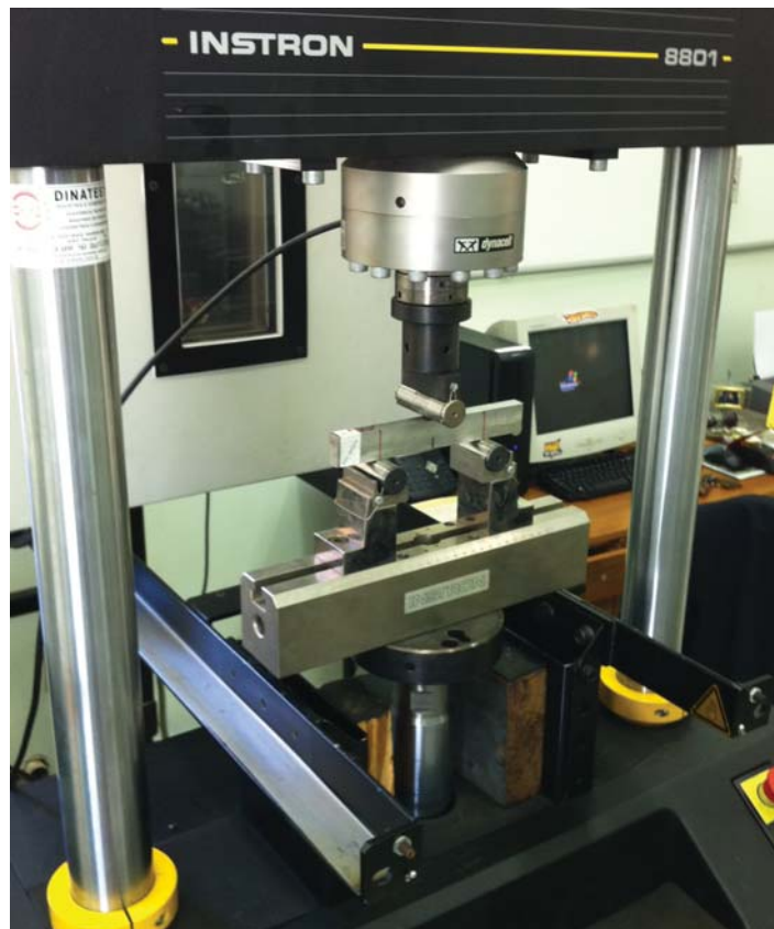
Figura 34 – Representação do dispositivo para ensaio CTOD .
