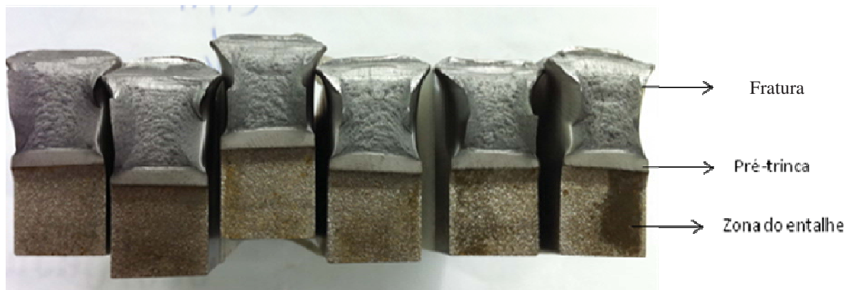
Figura 39 – Corpos de prova CP1, CP2, CP3 (respectivamente) com entalhe no metal base, após rompimento. As setas indicam as diferentes regiões do corpo-de-prova
