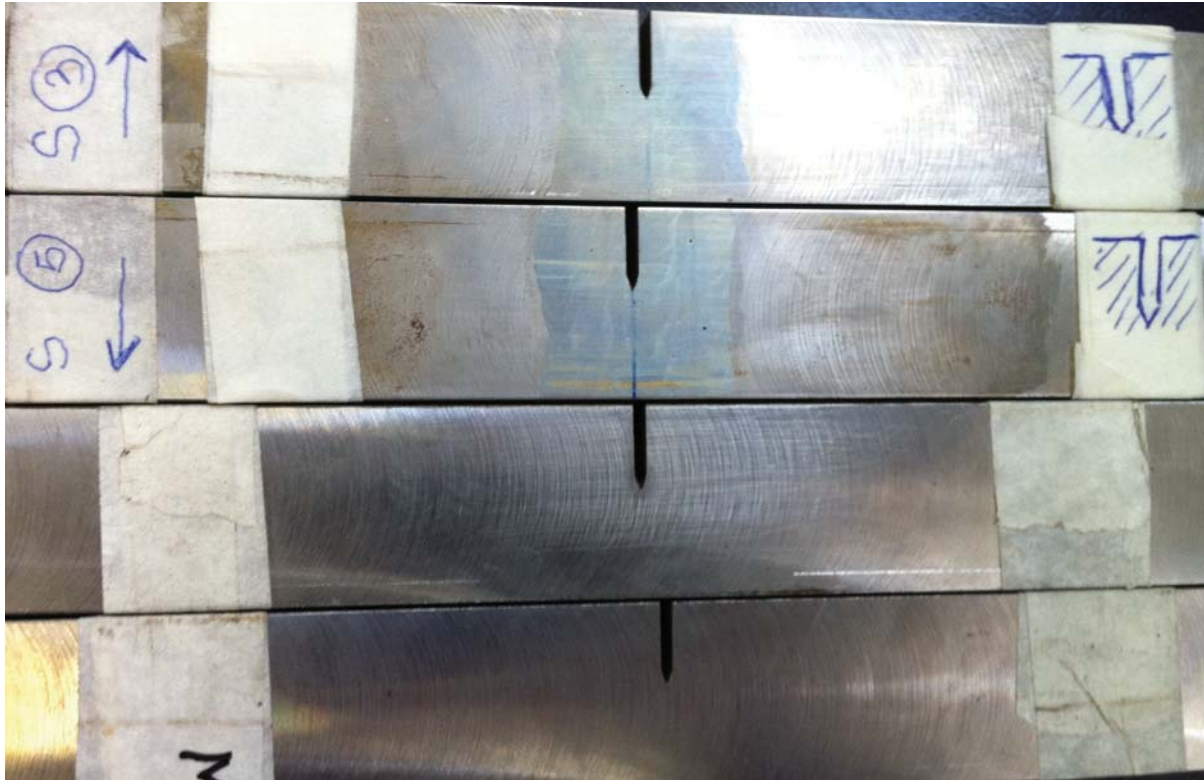
Figura 29 – Corpos de prova SE (B) (solda) após realização do entalhe – Vista superior
