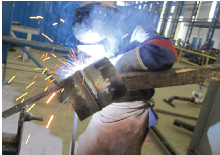
Figura 14 – Ilustração da soldagem do tubo de teste
