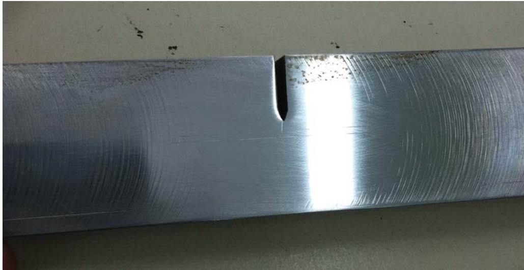
Figura 31 – Corpo de prova SE (B) (Metal base) após realização da pré-trinca
