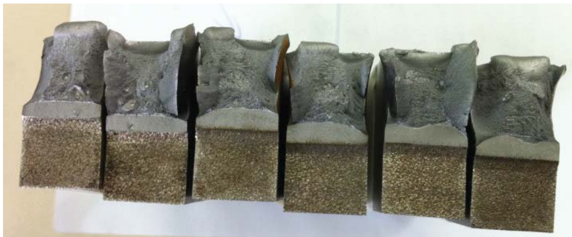
Figura 40 – Corpos de prova CP4, CP5, CP6 (respectivamente) com entalhe na solda, após rompimento
