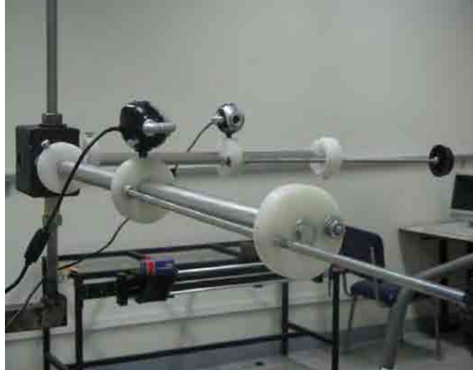
Figura 4.3 – Guias de aço da base de sustentação
