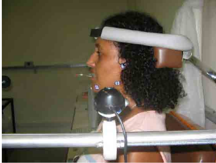
Figura 4.2- Sistema de fixação da cabeça do voluntário
