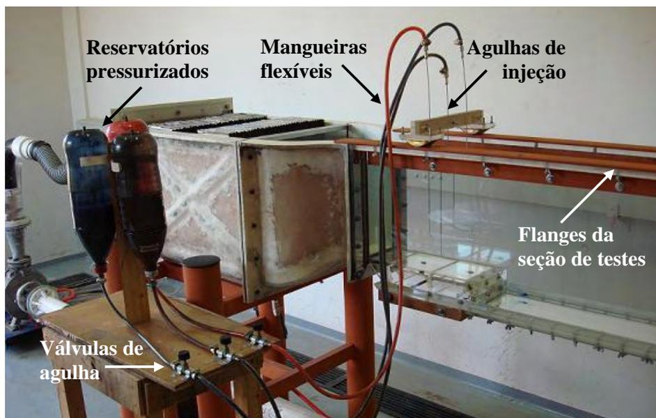
Figura 3.5: Esquema para a injeção de corante líquido.
