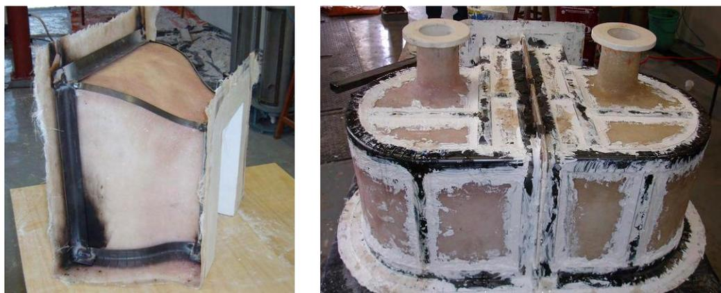
Figura A.12: Reforços de aço sobre peças de fibra de vidro.
