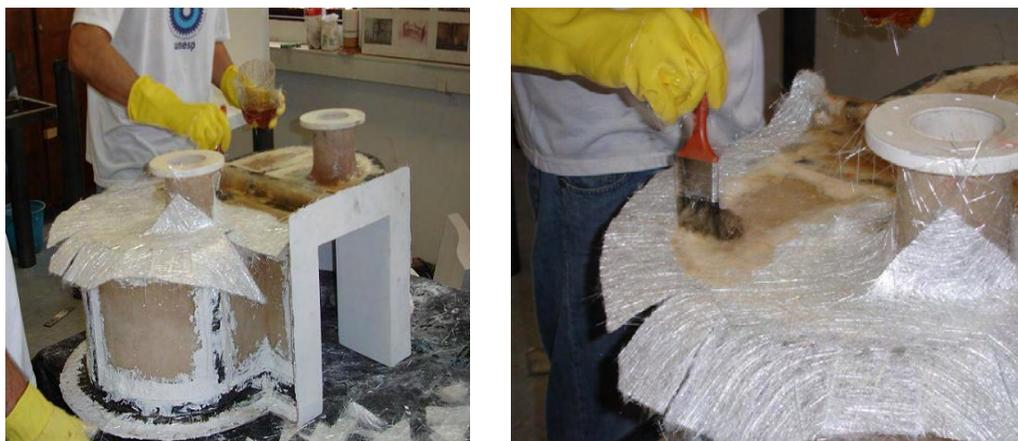
Figura A.11: Processo de laminação de fibra de vidro.
