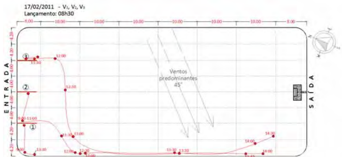
Figura 34 - Comportamento dos flutuadores V_1 , V_2 , V_3 no ensaio 2 da 2ª etapa
