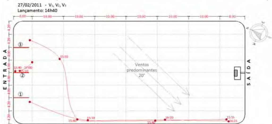
Figura 52 - Comportamento dos flutuadores V_1 , V_2 , V_3 no ensaio 5 da 2ª etapa
