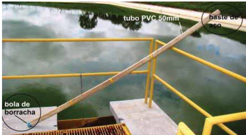
Figura 19 - Coletor de amostras com abertura inferior controlada por haste de aço na extremidade oposta.
