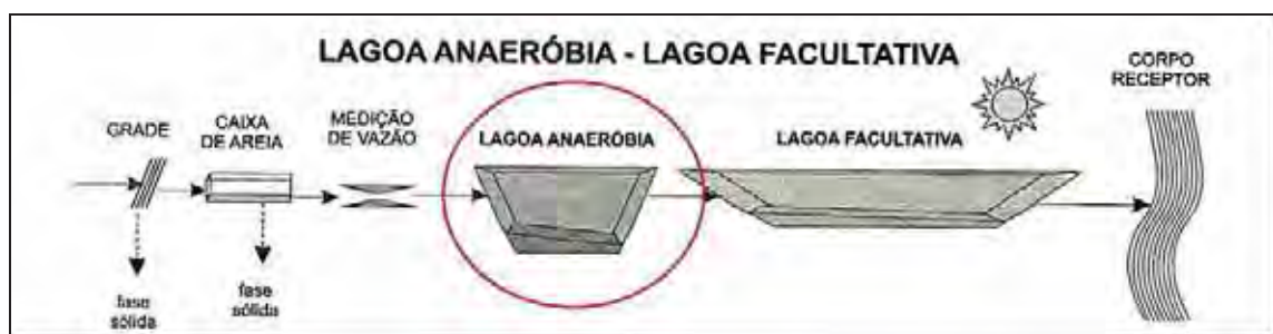
Figura 1 - Sistemas de lagoas anaeróbias seguidas por lagoas facultativas
