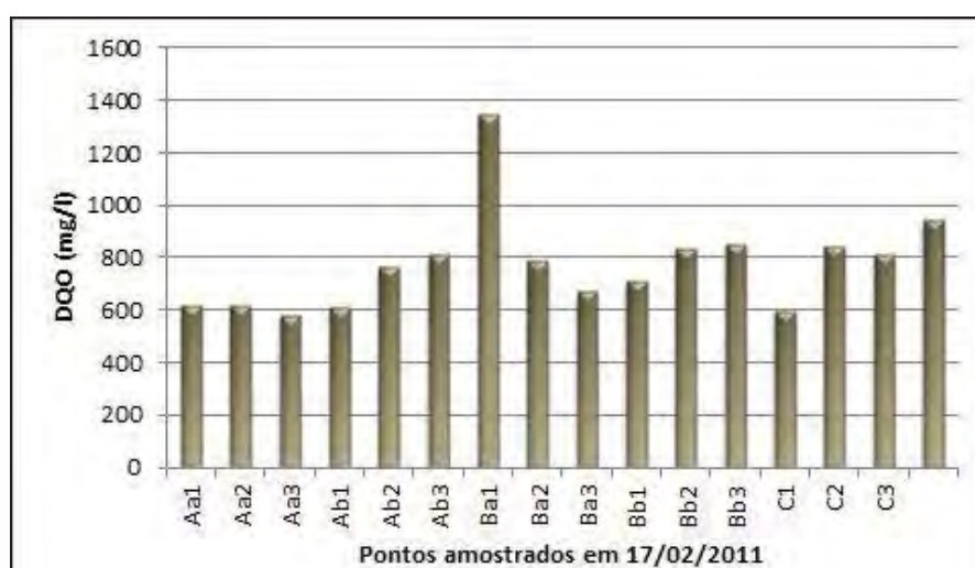
Figura 60 - Concentração de DQO nos 3 níveis da lagoa em todos pontos amostrados (17/02/2011).
