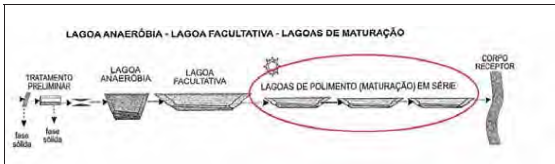
Figura 4 - Esquema de uma lagoa de maturação
