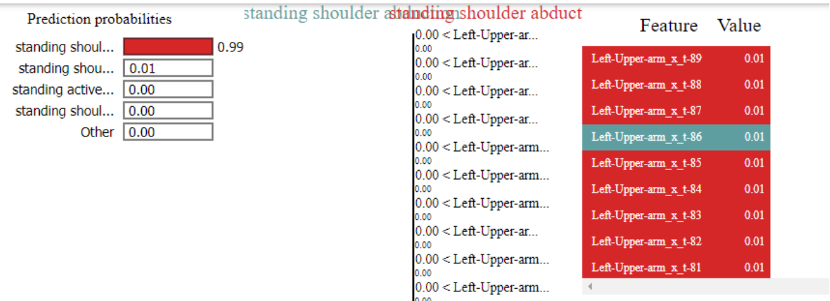
Figura 36 – Captura de tela mostrando que ao aplicar a biblioteca LIME no modelo de IA, os dados eram retornados com indicação de frame e não forneciam uma explicação consistente.
