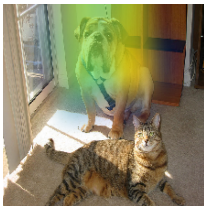
Figura 13 – Exemplo de uso da biblioteca ELI5, indicando a área mais relevante para a classificação através de um mapa de calor sobreposto a imagem original.
