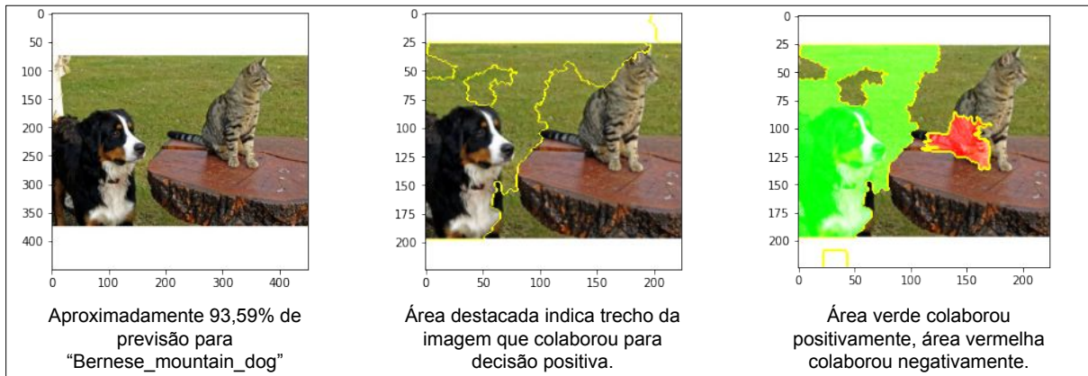
Figura 22 – Resultados dos experimentos realizados no Exemplo 2, utilizando a biblioteca LIME em um modelo de identificação de imagens.
