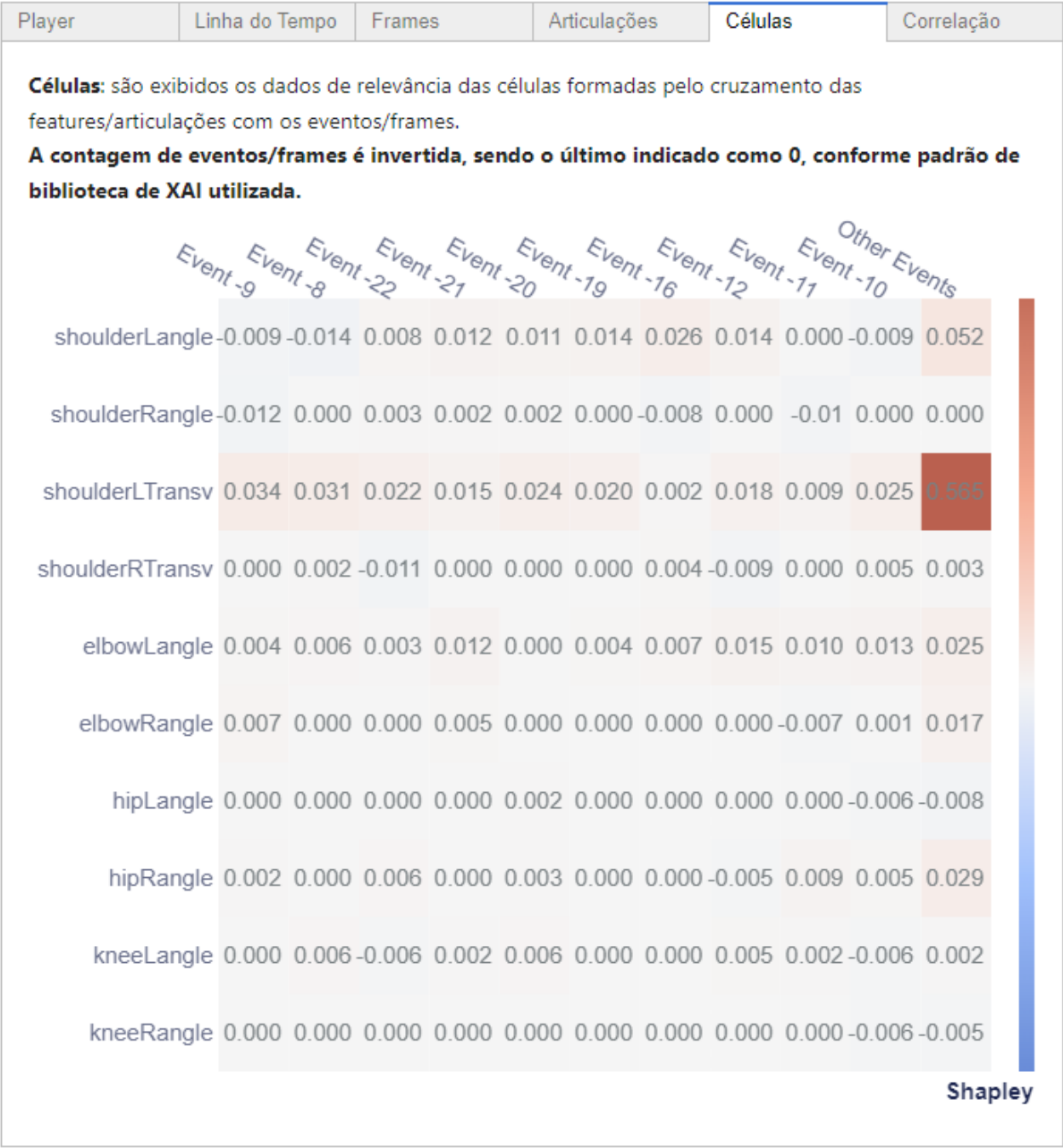
Figura 53 – Captura de tela mostrando a interface do MoveXAI na aba "Células", onde o gráfico de células da Biblioteca XAI é utilizado para demonstrar o impacto das principais articulações e frames na classificação. É apresentada uma matriz com o eixo horizontal mostrando as articulações e o eixo vertical os frames , com a cor variando de acordo com o impacto da célula (articulação/ frame ) na classificação.
