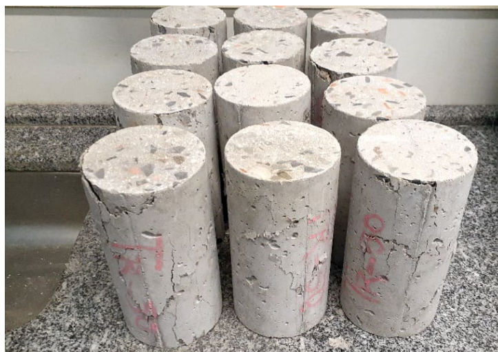
Figura C.2 – Ensaio de resistência à compressão traço 50%
