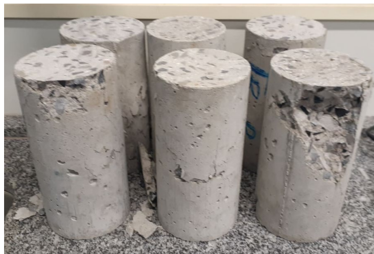
Figura C.1 – Ensaio de resistência à compressão traço padrão.
