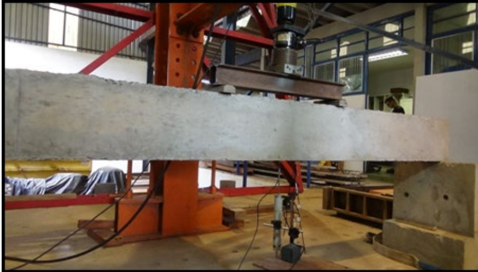
FIGURA 35 – ARRANJO COM TRANSDUTOR POSICIONADO.
