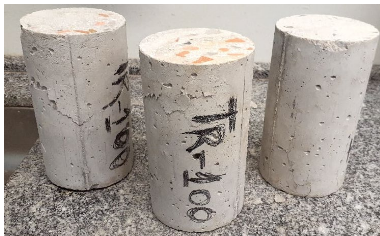
Figura C.3 – Ensaio de resistência à compressão traço 100%
