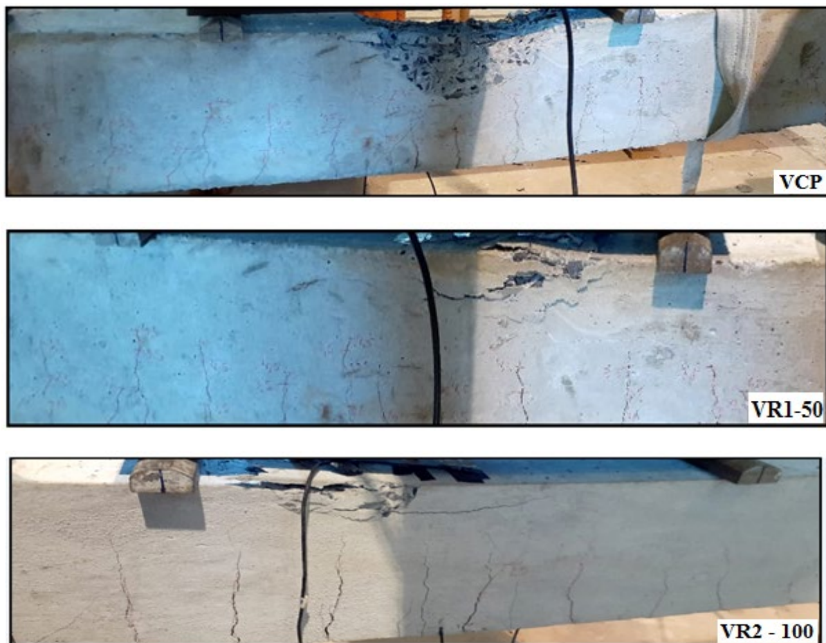
FIGURA 44 – FISSURAÇÃO E MODO DE FALHA: DO AUTOR (2021)
