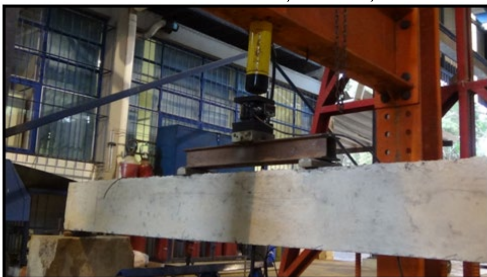
FIGURA 34- ARRANJO PARA APLICAÇÃO DE FORÇA NA VIGA.
