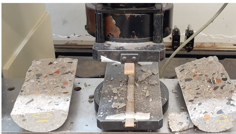
Figura C.6 – Ensaio de resistência à tração traço 100%
