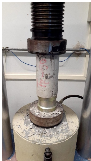
Figura B.1 – Resistência à compressão
