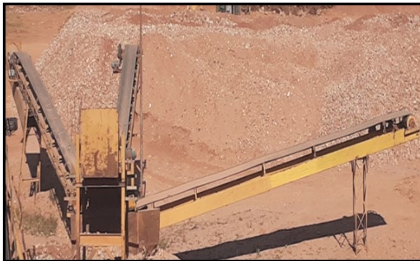
FIGURA 15 – PENEIRADOR PARA SEPARAÇÃO DO AGREGADO GRAÚDO RECICLADO.
