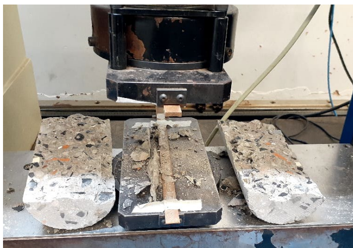
Figura C.5 – Ensaio de resistência à tração traço 50%
