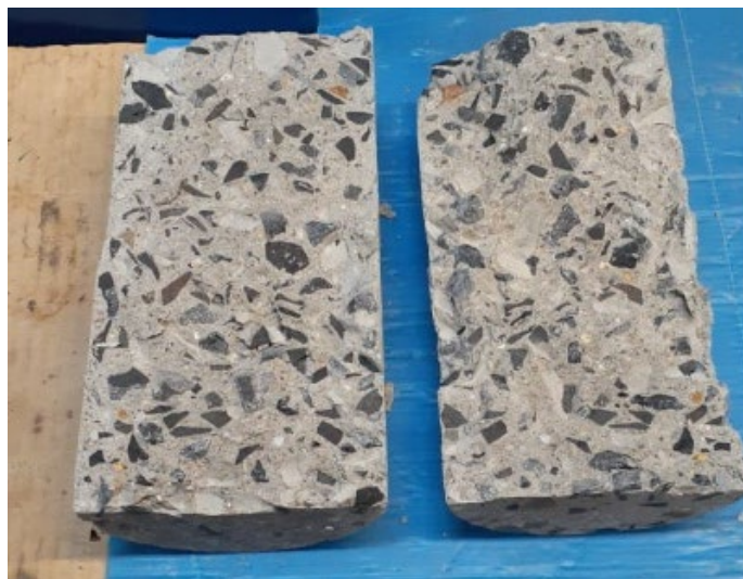
Figura C.4 – Ensaio de resistência à tração traço padrão.
