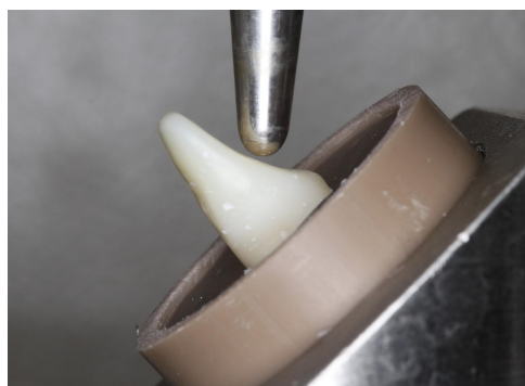
Figura 5 - Amostra posicionado para teste de ciclagem mecânica
