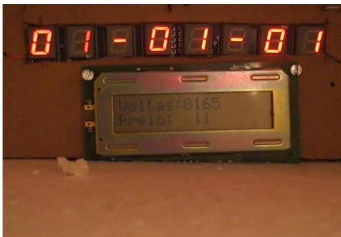
Figura 1. Imagem do display desenvolvido, mostrando os dígitos de identificação do participante, condição e tentativa (superior) e das medidas de tensão de freio e número de voltas.
