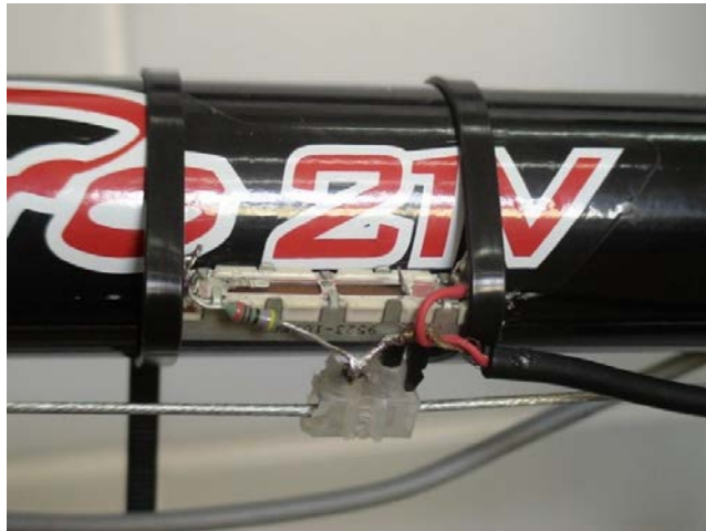
Figura 2: Um potenciômetro foi acoplado no cabo de freio.
