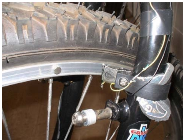
Figura 3. Um sensor acoplado ao garfo, e um conjunto ímãs colocados na roda.
