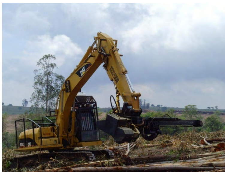
Figura 10: Máquina base Caterpillar 320 CL equipada com Processador Florestal.
