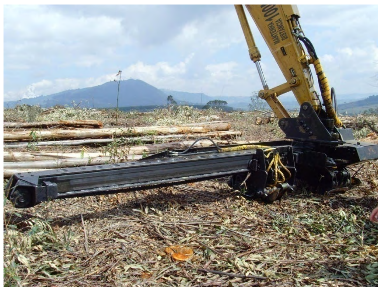
Figura 11: Cabeçote Processador Florestal da marca MSU.
