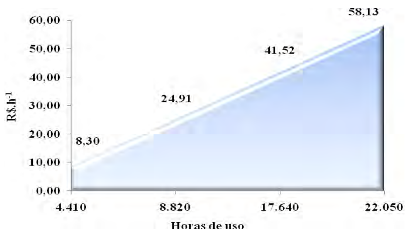
Figura 22: Simulação dos custos de reparos e manutenção do Feller-Buncher .
