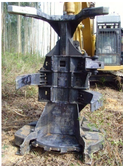
Figura 9: Cabeçote Feller-Buncher da marca Risley .
