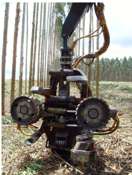
Figura 7: Cabeçote Harvester da marca Valmet .
