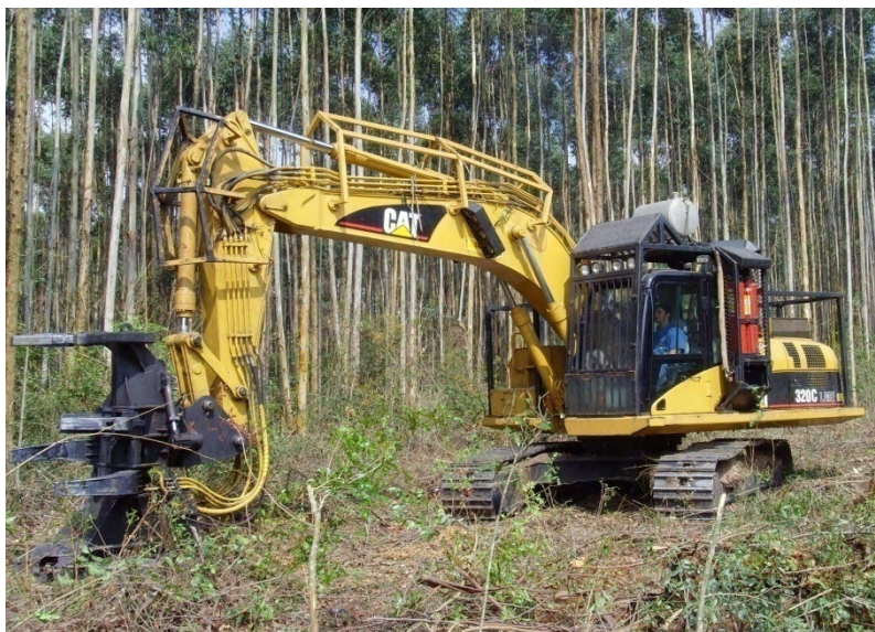
Figura 8: Máquina base Caterpillar 320 CL equipada com o cabeçote Feller-Buncher .
