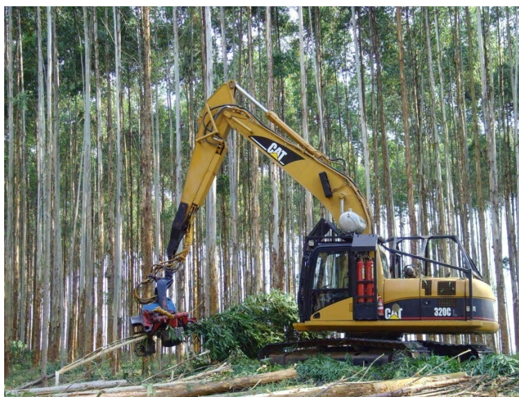
Figura 6: Máquina base Caterpillar 320 CL equipada com o cabeçote Harvester .
