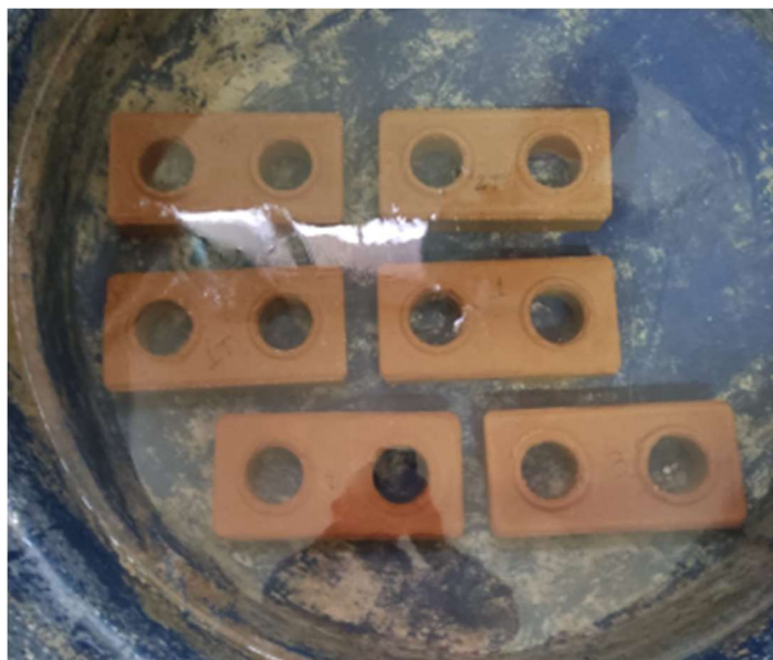
Figura 22: Tijolo imerso em tanque de água por 24 horas
