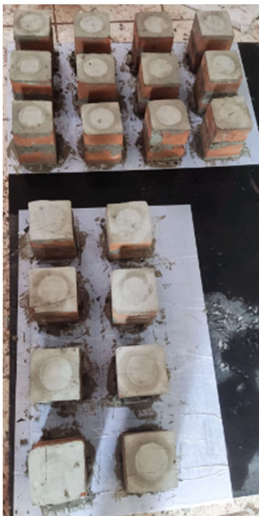
Figura 25: Moldagem do Corpo de Prova Fonte: O Autor
