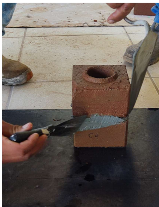
Figura 24: Moldagem do Corpo de Prova Fonte: O Autor
