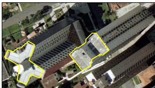
Figura 39: Projeções na imagem aérea dos contornos obtidos a partir do MDE/laser representado os telhados dos edifícios avaliados no experimento 5.
