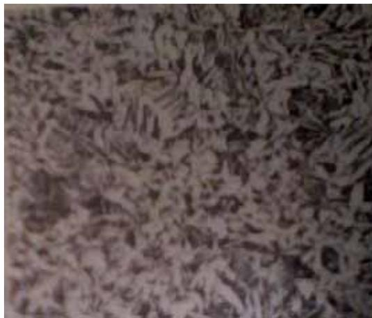
Figura 13 – Microestrutura do aço A-516 Gr.70 (ampliação 100x) na condição de laminado a quente e normalizado por austenitização a 1127°C (Atlas of Microstructures of Industrial Alloys, 1972).
