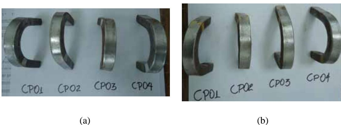
Figura 32 – Fotos dos Corpos de prova após serem submetidos aos ensaios de dobramento: (a) CP com tratamento térmico; (b) CP sem tratamento térmico.
