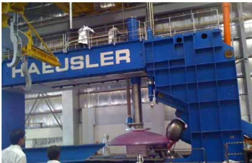
Figura 8– Exemplo de máquina de Abaular e Rebordear (Haeusler,2014)
