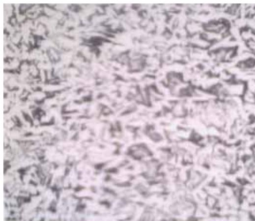
Figura 11 – Microestrutura do aço A-516 Gr.70 (ampliação 100x) na condição de laminado a quente (Atlas of Microstructures of Industrial Alloys, 1972)
