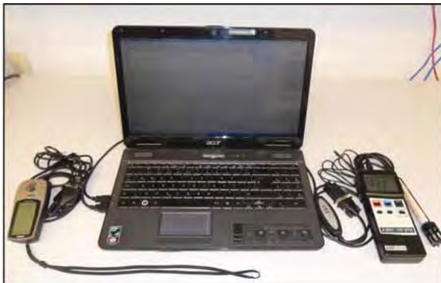
Figura 35: Forma e disposição que é instalado os dispositivos para a utilização do software, uso do GPS (à esquerda) e o Termohigrômetro (à direita).
