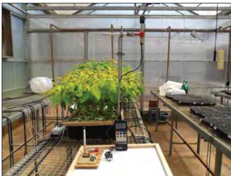
Figura 33: Forma de instalação e disposição do módulo transmissor no interior da casa de vegetação para a aquisição dos dados.
