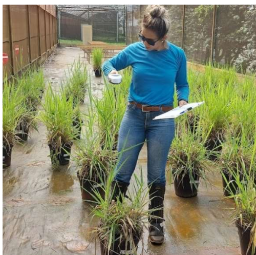
Figura 7 - Avaliação de NDVI com sensor Green Seeker .
