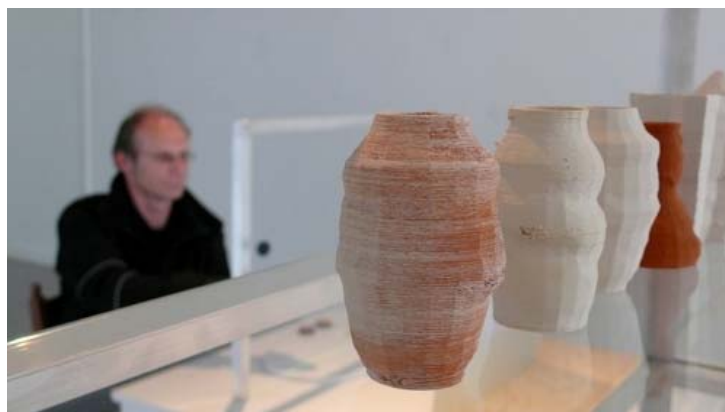
Figura 21: Vasos construídos na impressora 3D RepRap.
