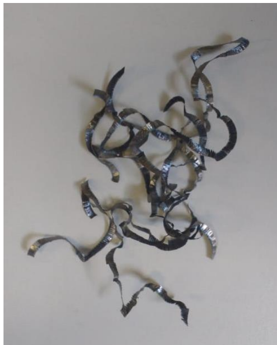
Figura 80 – Cavaco fita emaranhada do ensaio sob V_c=200\text{m/min} , f=0,4\text{mm} e a_p=1,5\text{mm} .
