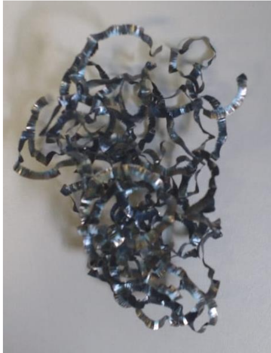
Figura 79 – Cavaco fita emaranhada do ensaio sob V_c=300\text{m/min} , f=0,3\text{mm} e a_p=1,0\text{mm} .
