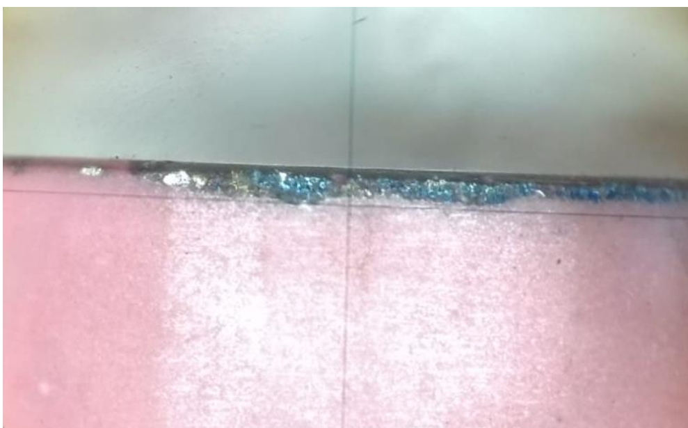
Figura 72 – Lascamento sob V_c = 250 m/min, f = 0,3 mm e a_p = 1 mm
