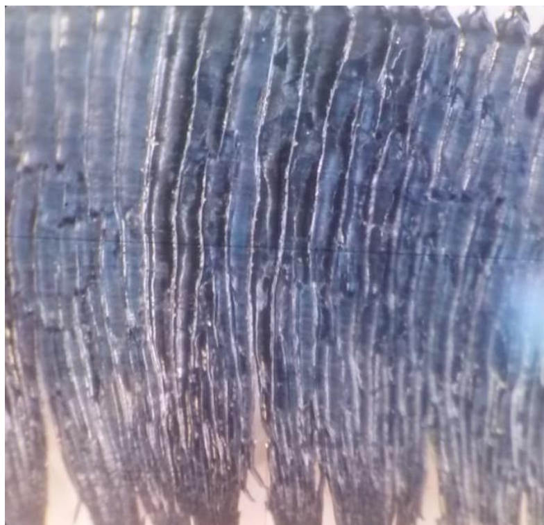
Figura 76 – Cavaco resultante do ensaio sob V_c = 160 m/min, f = 0,3 mm e a_p = 1,5 mm.
