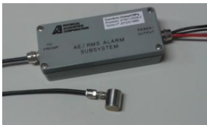
Figura 21 – Módulo de emissão acústica utilizado, com sensor piezoelétrico e amplificador de sinal.
