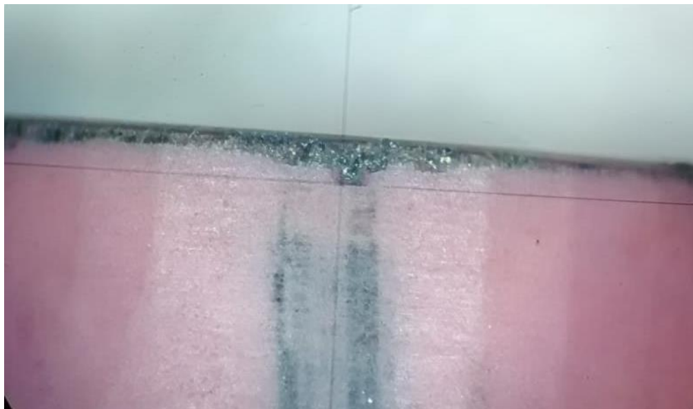
Figura 75 – Desgaste sob V_c = 200 m/min, f = 0,4 mm e a_p = 1,0 mm
