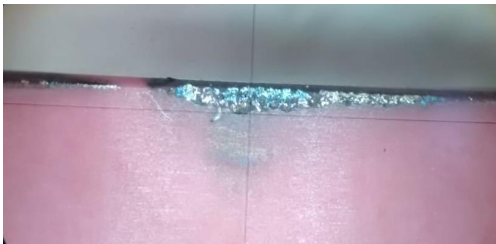
Figura 71 – Lascamento sob V_c = 300 m/min, f = 0,3 mm e a_p = 1 mm
