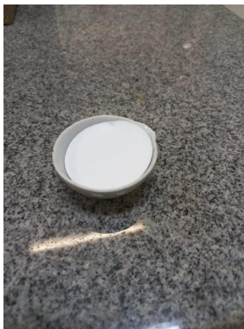
Figura 7 – Vista do conjunto membrana e cadinho
