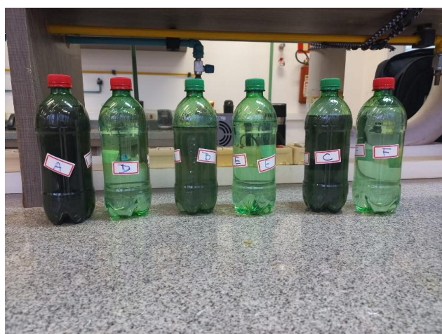
Figura 10 – Comparação visual das amostras de água pré e pós-tratamento em diferentes condições de operação do lavador Venturi: A) Água bruta (300 L/h); B) Água bruta (400 L/h); C) Água bruta (500 L/h); D) Água tratada (300 L/h); E) Água tratada (400 L/h); F) Água tratada (500L/h)
