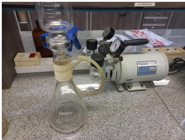
Figura 8 – Sistema de filtração com bomba de vácuo
