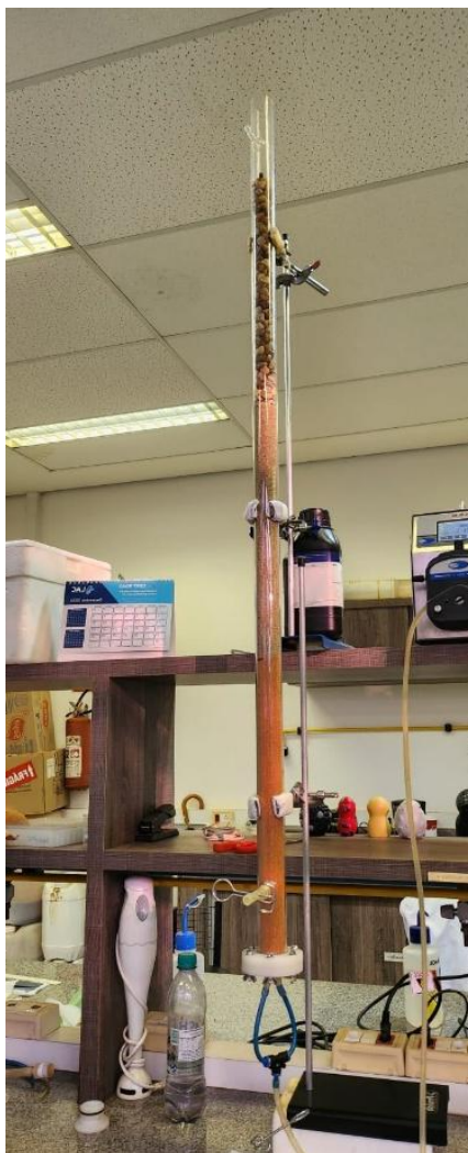
Figura 5 – Vista da coluna filtrante
