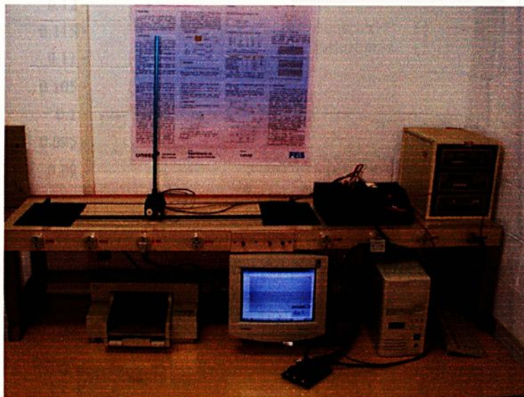
Figura 4.11 – Estrutura utilizada na implementação do sistema pêndulo invertido.
