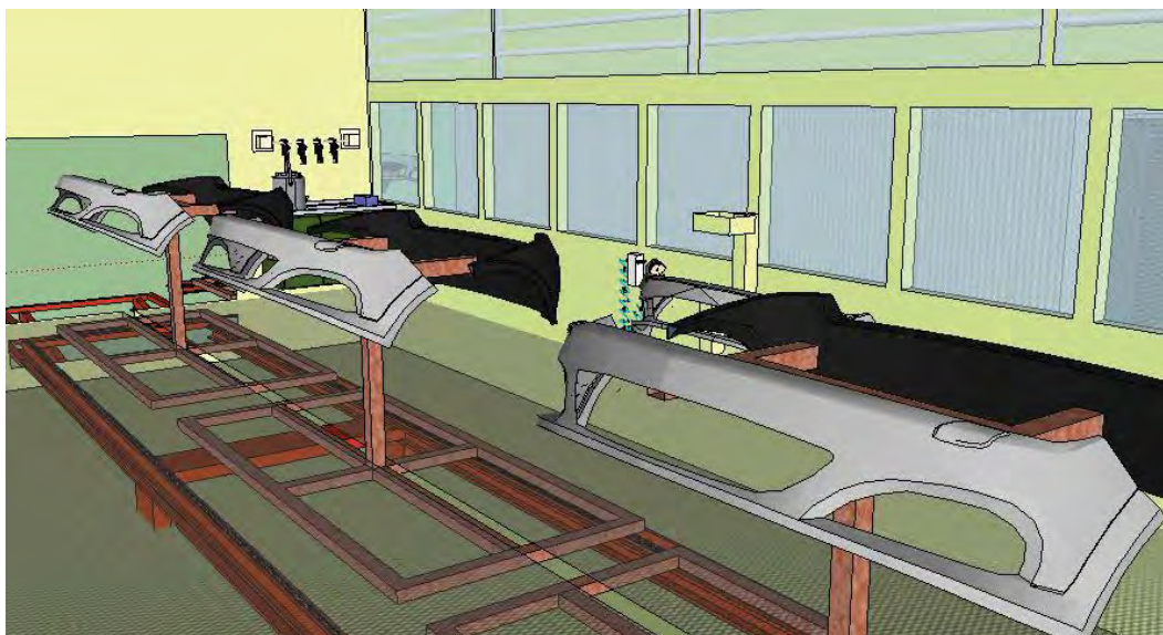
Figura 27 – Linha de pintura da Cabine de Reparos (Material fornecido pela GM)
