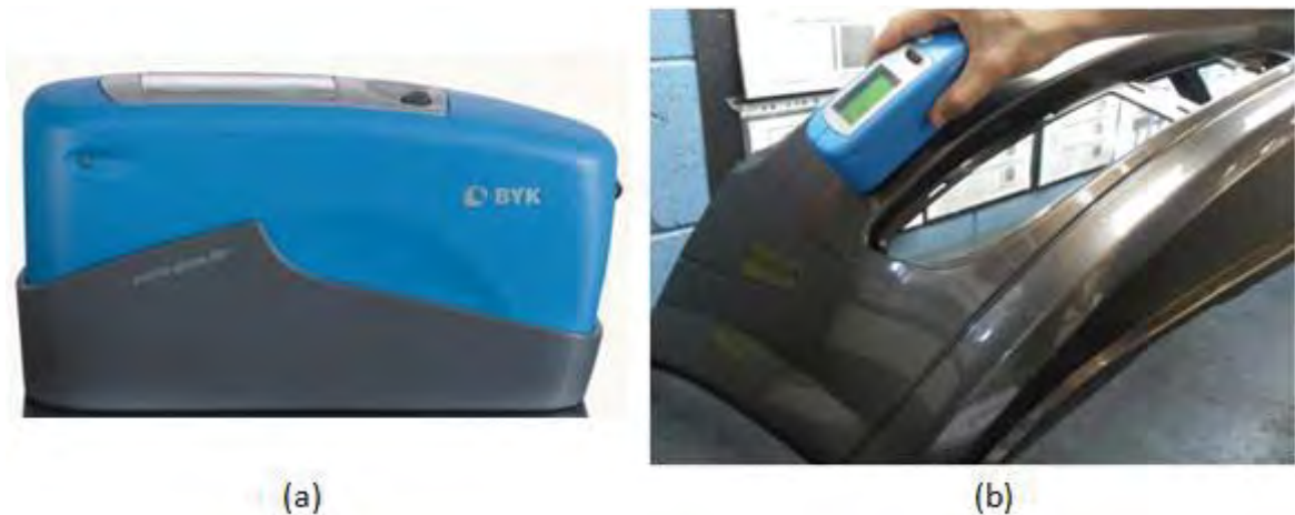
Figura 16 – Equipamento Micro TRI-Gloss do fornecedor BYK (a) e exemplo de medição de brilho com o TRI-Gloss em um pára-choque (b) (Site do fornecedor / Material fornecido pela GM)
