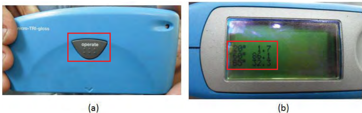
Figura 17 – Botão “Operate” (a) e resultado apresentado pelo equipamento (b) (Material fornecido pela GM)
