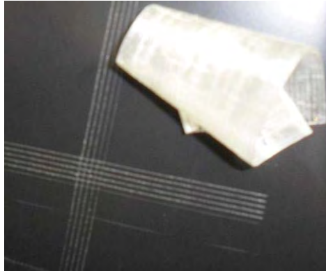
Figura 14 – Arrancamento da fita adesiva da peça (Material fornecido pela GM)
