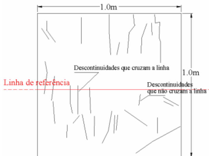
Figura 11: Mapeamento geomecânico em janelas amostrais por meio de linha de referência em maciço com descontinuidades sem persistência (escala gráfica).
