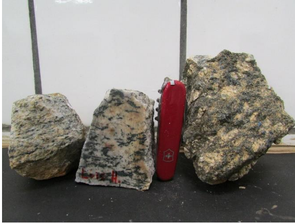
Foto 3.3: Amostras de rocha alcalina com estrutura anisotrópica ou protomilonítica (Da esquerda para direita: 78A, Luis H, 78B).
