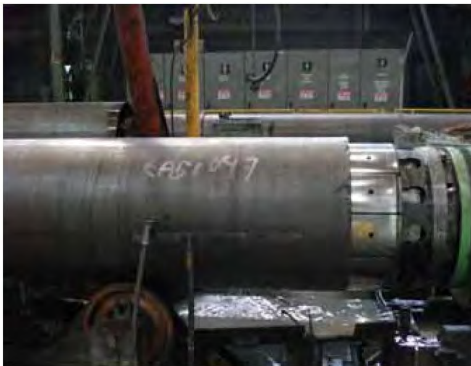
Figura 6: Equipamento para expansão a frio “E” (GODOY, 2008).
