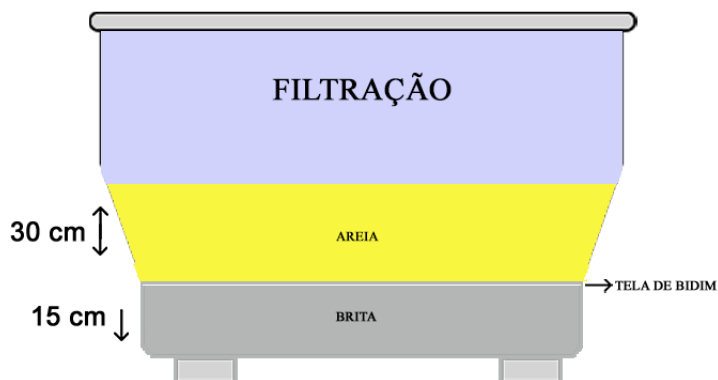
Figura 41 - Estrutura do tanque de filtração na Santa Casa de Misericórdia de Fernandópolis
