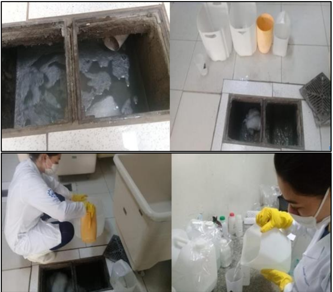
Figura 28 - Coleta de efluente para amostragem na Santa Casa de Fernandópolis.
