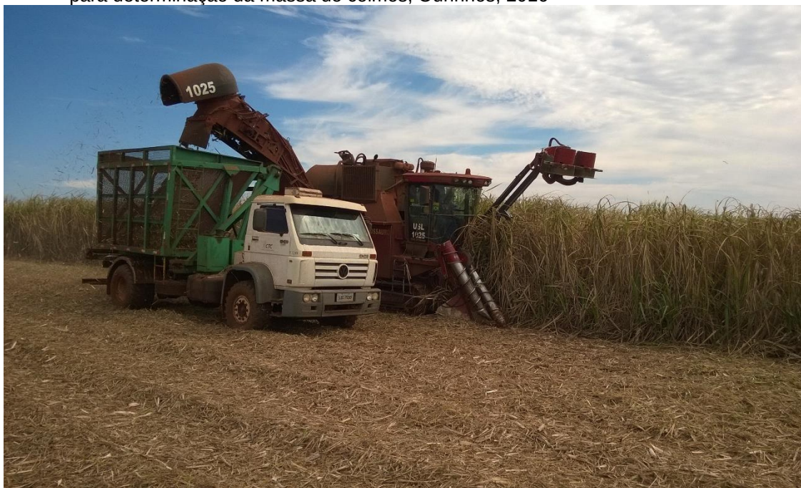
Figura 8 - Caminhão transbordo instrumentado do Centro de Tecnologia Canavieira (CTC), utilizado para determinação da massa de colmos, Ourinhos, 2016
