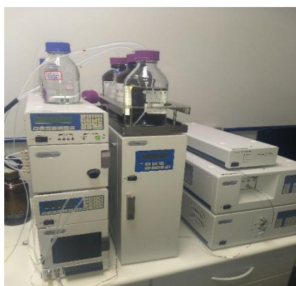
Figura 3: Sistema CLAE empregado em todas as etapas do presente trabalho (Jasco, Japão)
