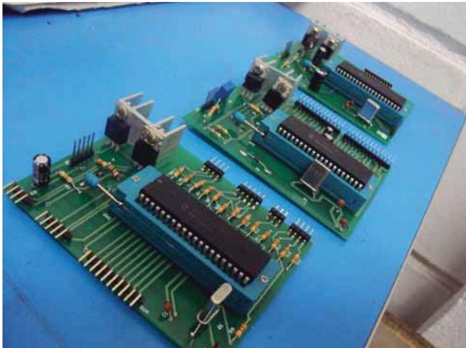
Figura 12 - Placas de circuito impresso após soldagem de componentes
