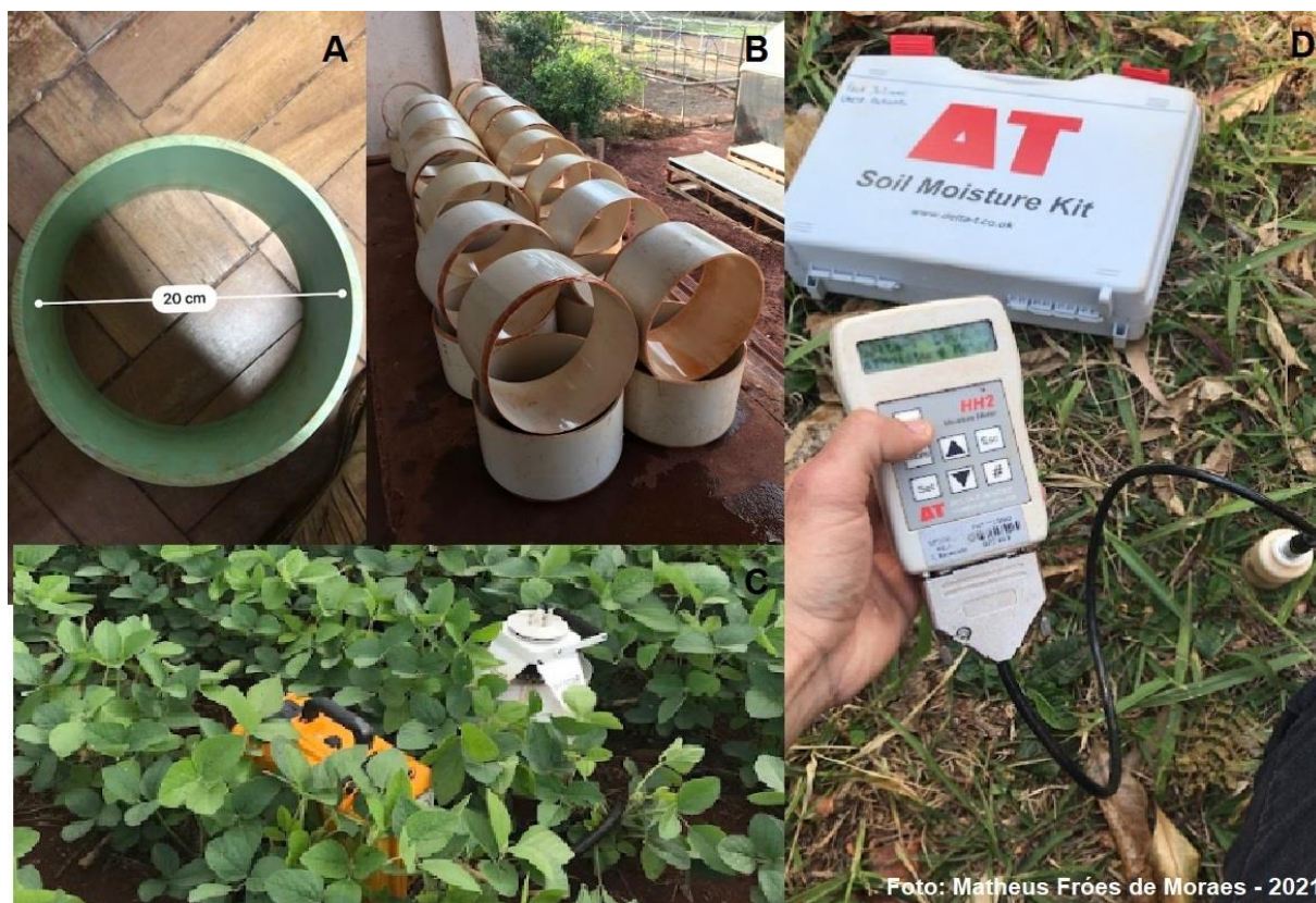
Figura 6 - Anéis de PVC utilizados como sítio de análise de fluxo de CO 2 (A, B); aferição de fluxo com IRGA a campo (C) e determinação de temperatura e umidade com sensor ML3 (D).
