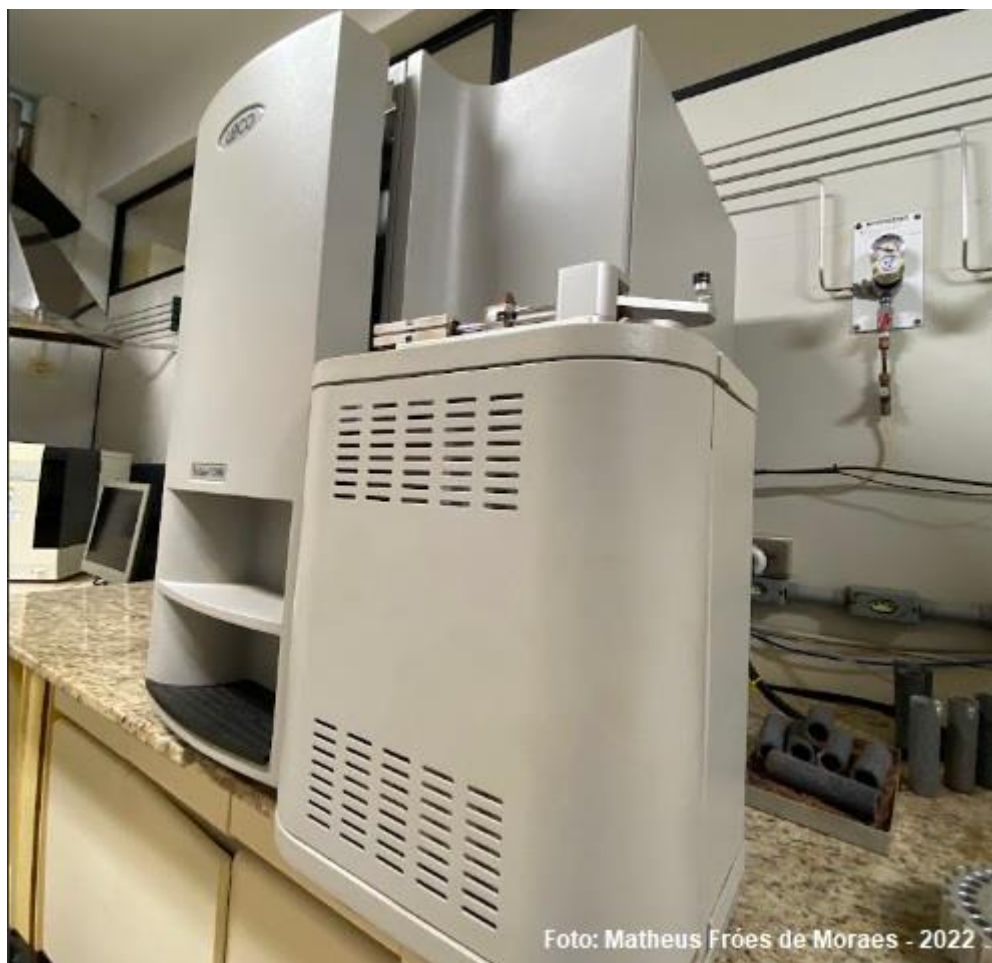
Figura 4 - Analisador TruSpec CHNS - LECO ® utilizado para aferição dos teores de C e N nas amostras de MS. Fonte: Autor, 2023.
