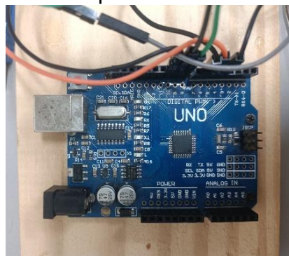
Figura 9: Arduino UNO utilizado para a leitura das medidas de temperatura.
