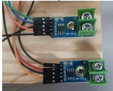
Figura 10: Sensores MAX6675 utilizados para a leitura de temperatura com termopares.
