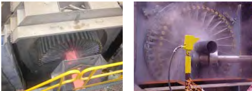
Figura 37 - Processo de têmpera dos tubos. Foto à esquerda mostrando o tubo aquecido à temperatura de austenitização entrando no cabeçote de têmpera. Foto à direita mostrando o tubo temperado saindo do cabeçote de têmpera.
