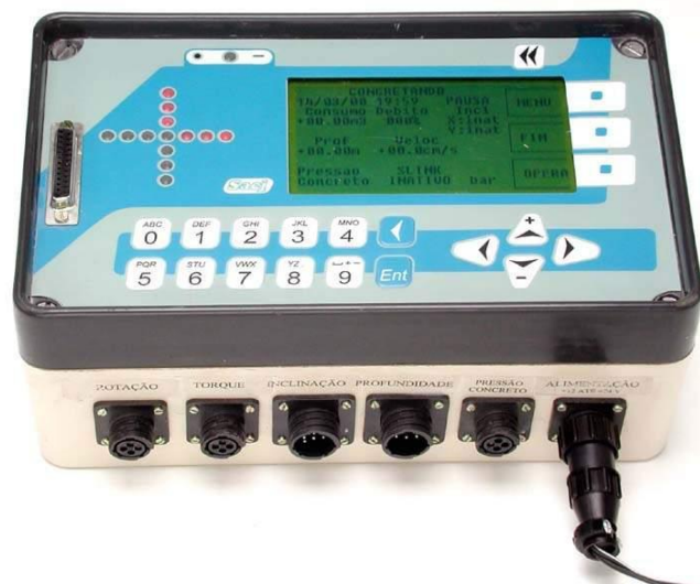
Figura 18. Aparelho de monitoramento para estacas hélice contínua TARACORD.
