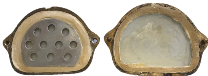
Figura 3- Mufla aberta para prensagem da resina
