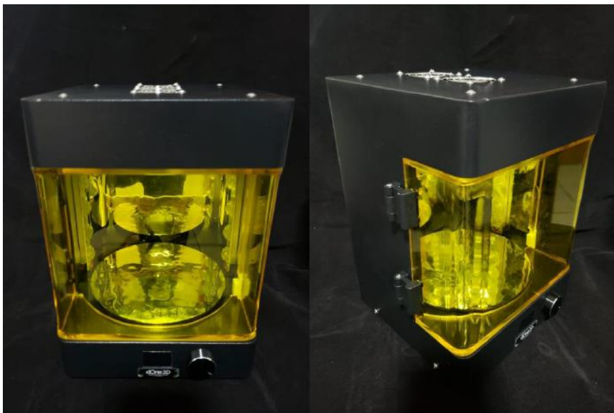
Figura 9- Equipamento Curing Box para polimerização adicional em luz UV
