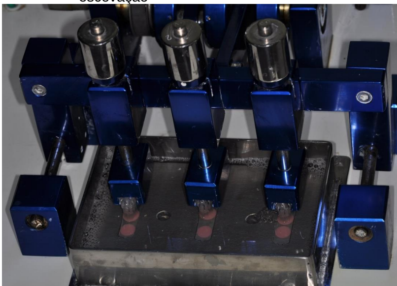
Figura 15- Bandeja com sua respectiva placa horizontal removível contendo três cavidades retangulares na posição referente aos respectivos braços metálicos secundários. Em cada cavidade retangular é possível adaptar 3 espécimes para o ciclo de escovação
