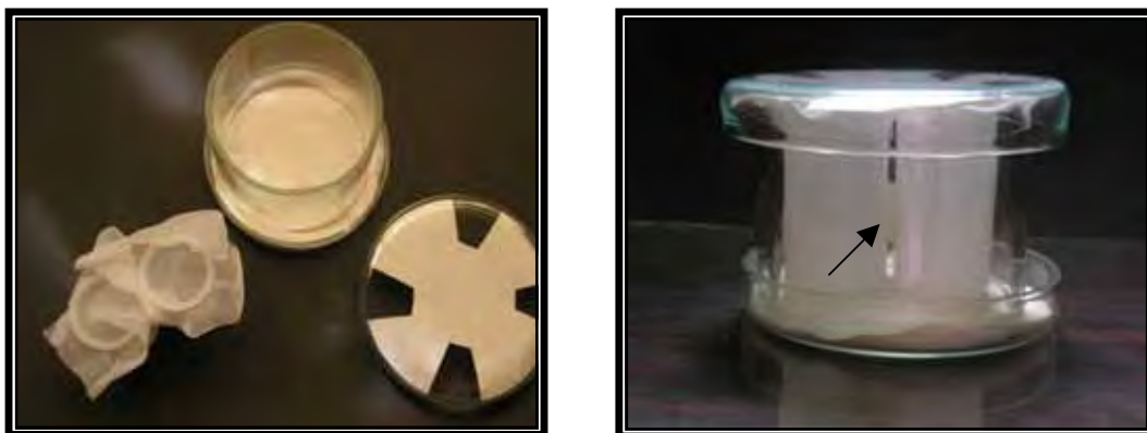
Figura 3. Visualização de uma câmara úmida e dos recipientes plásticos interligados (→) e vedados com tecido voile , onde os grupos de ovos e larvas foram mantidos durante a fase larval.
