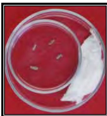
Figura 6. Câmara úmida composta de duas placas de Petri e algodão umedecido para verificação da extrusão do patógeno.
