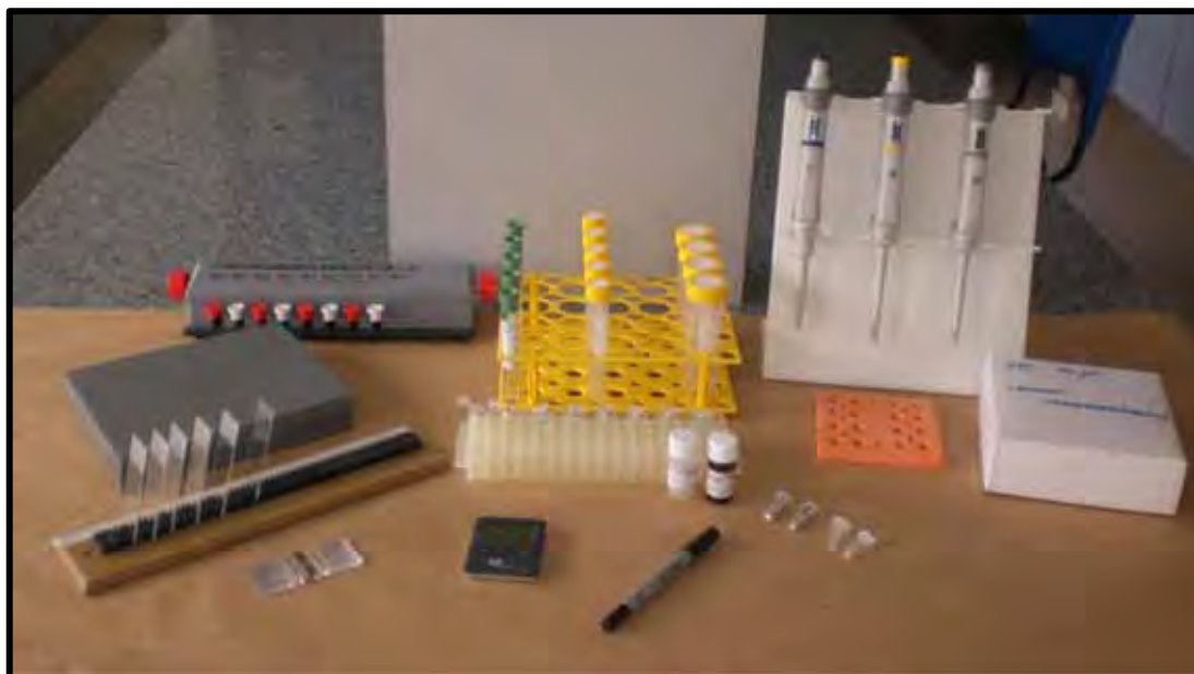
FIGURA 8. Materiais para processamento laboratorial, armazenamento e realização dos testes NBT: caixa de papelão; caixa porta-lâmina; câmara de Neubauer; caneta; contador de células; estimulante; flutuador; lâmina extensora, lâminas foscas; micropipetas; microtubos plásticos; relógio;
