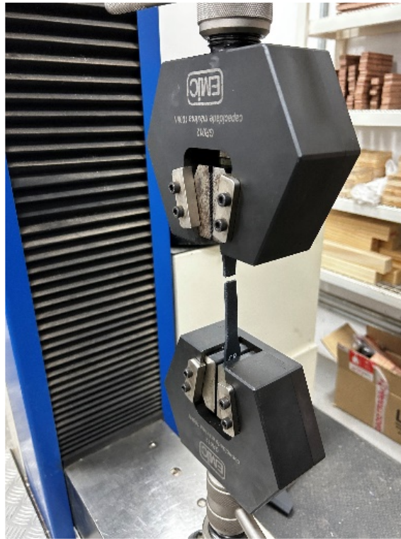
Figura 29 - Ensaio de tração em execução na máquina EMIC.
