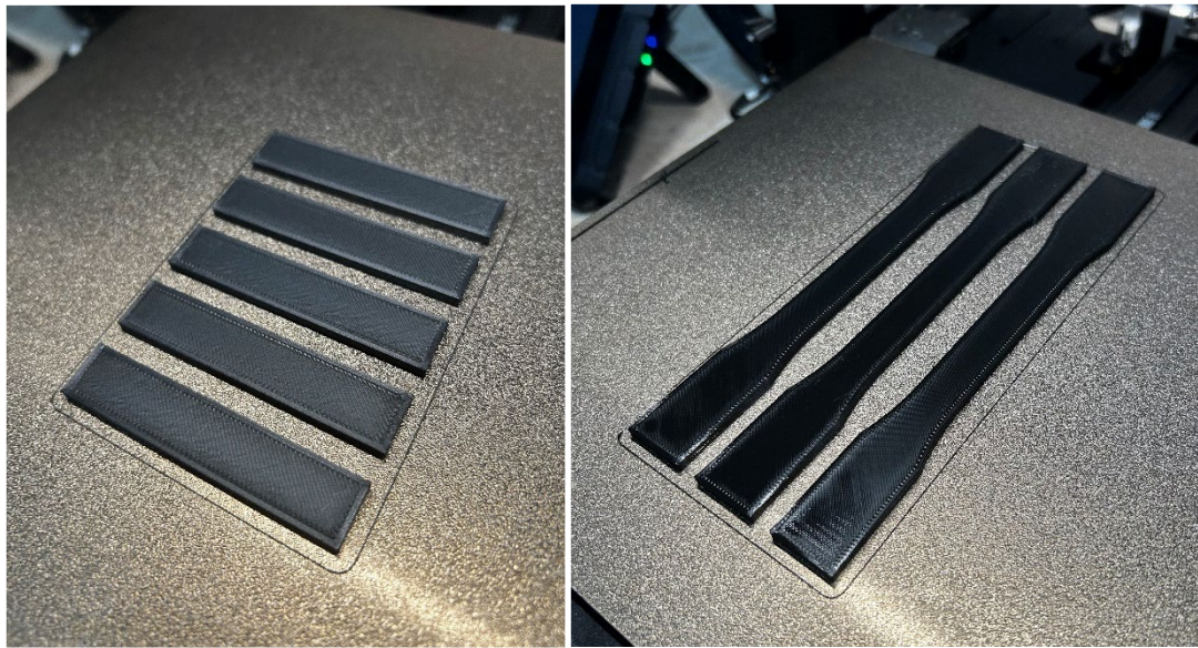
Figura 26 - Corpo de prova impresso antes do tratamento térmico.
