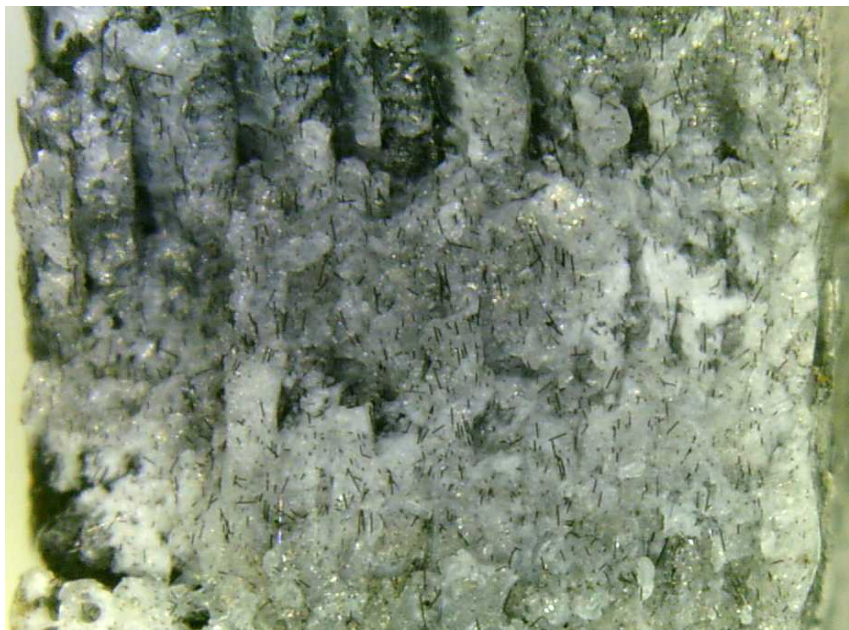
Figura 39 - Imagem microscópica de fratura no PLA CF.
