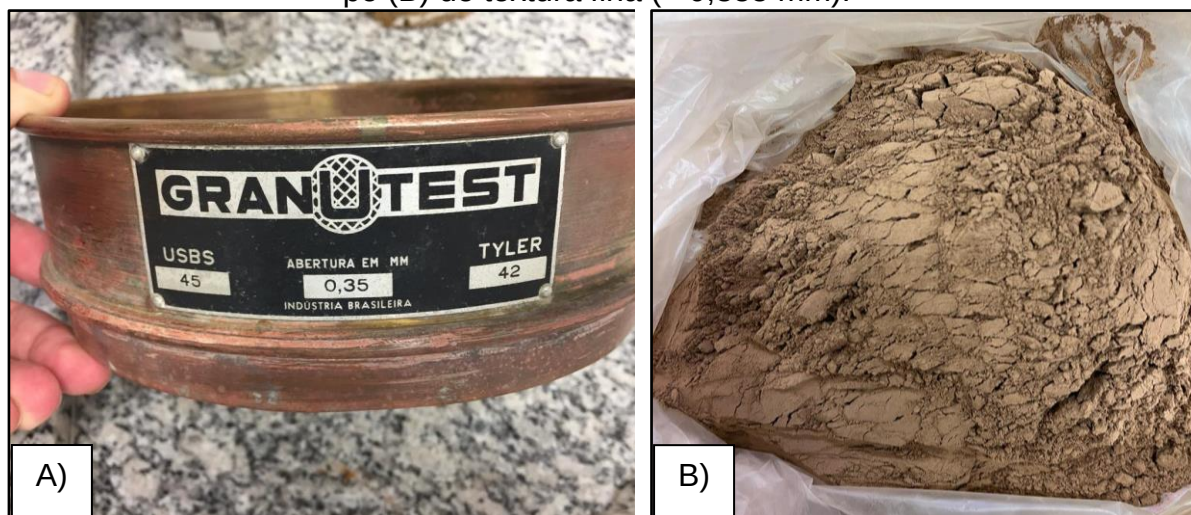
Figura 18 - Peneiramento da amostra de lodo desaguada e seca (A) resultando em pó (B) de textura fina ( < 0,355 mm).
