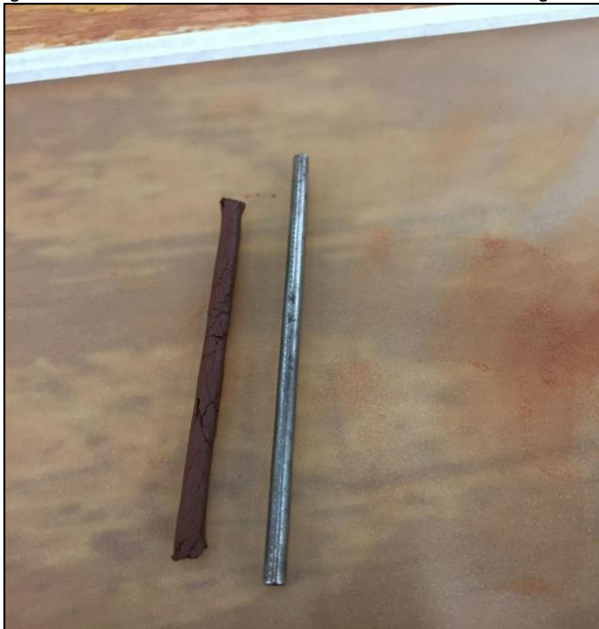
Figura 26 - Ensaio de Limite de Plasticidade, amostra e gabarito
