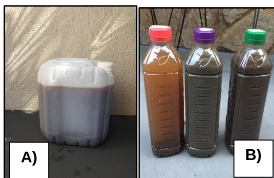
Figura 13 - Armazenamento de amostra LETA em bombonas de polietileno de 20 litros (A) e em embalagens de 1 litro (B)
