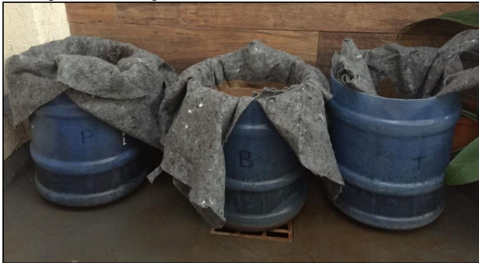
Figura 14 - Desaguamento de LETA das ETAs CB, CT e CP
