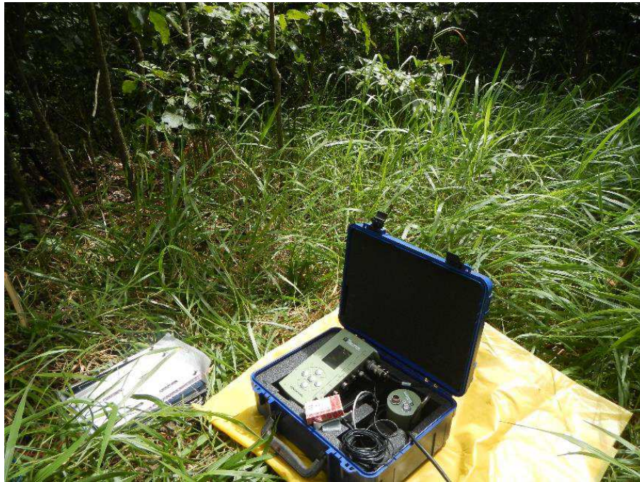
Foto 3. Equipamento de banda larga ( Trillium Compact Broadband ) que foi instalado no ponto PL2.
