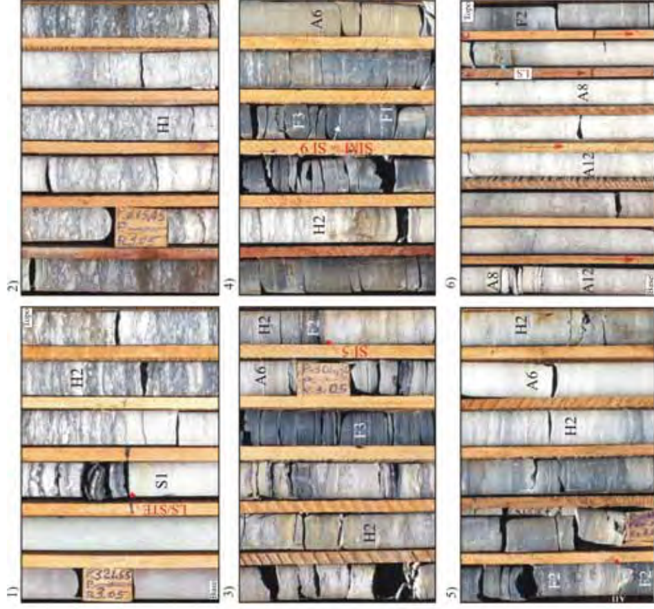
Figura 12B - Seção colunar da Formação Palerme no poço FP-09-PR e ilustração de suas principais facies sedimentares. 1) Passagem entre as formações Rio Bonito (facies S1) e a Formação Palerme (facies H2). O contato entre as unidades é interpretado como um limite de seqüências amalgamado a uma superfície transgressiva de erosão (LS/STE). 2) Facies heterolítica fortemente bioturbada (H1). 3) Facies heterolítica bioturbada (H2), folhelho carbonoso (F3) e arenito com hummocky (A6). A base do folhelho F2 marca uma superfície de inundação (S1). 4) Facies heterolítica bioturbada (H2) sobreposta por folhelho bioturbado contendo gretas de sinerese (F1). O contato de F1 com F3 reflete uma superfície de inundação máxima (S1-SIM). 5) Folhelho cinza escuro (F2) interrompido por uma superfície de inundação demarcada por suítes de Glossifungites (seta vermelha). Acima, facies heterolítica bioturbada (H2) intercalada com uma camada de arenito com laminação ondulada truncante (A6). 6) Alternância entre arenito fino com interlaminações pelíticas, bioturbado (A12) e arenito fino, com laminação horizontal / cruzada de baixo ângulo (A8). O contato com o Membro Taquaral (Fm. Irati) é interpretado como um limite de seqüências (LS), sendo identificado por um nível pirítico (seta azul). Diâmetro dos testemunhos = 3,5cm.
