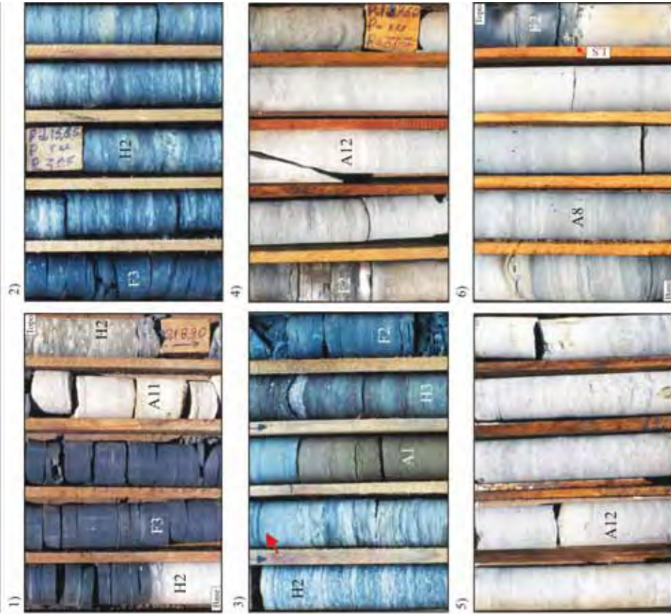
Figura 11B - Seção colunar da Formação Palermio no poço FP-05-PR e ilustração de suas principais fácies sedimentares. 1) Arenito com interlaminções pelíticas (H2) recoberto por folhelhos pretos (F3), evidenciando uma superfície de inundação (S12). Arenito sutilmente estratificado (A11) e fácies heterolítica bioturbada (H2). 2) Folhelho cinza escuro a preto (F3) sobreposto pela fácies (H2). 3) Fácies heterolítica (H2) exibindo uma superfície de inundação de alta energia, erosiva, caracterizada pela presença de suítes de Glossifungites (seta vermelha). Arenito amarelado com matriz argilosa, sutilmente estratificado (A1) sobrepõe a fácies H2 e é sobreposto pela fácies H3. Notar as bandas avermelhadas e os pavimentos areno-conglomeráticos. A base do folhelho F2 marca a superfície de inundação máxima. 4) Arenito fino, bioturbado (A12) interrompido por uma camada centimétrica de folhelho cinza escuro que marca uma superfície de inundação. 5) Arenito fino, bioturbado (A12). Notar que as lâminas pelíticas intercaladas foram rompidas pela ação de organismos escavadores. 6) Arenito com laminação horizontal a cruzada de baixo ângulo ou maciço, por vezes bioturbado (A8) - Formação Palermio, sobreposto por folhelho cinza escuro (F2) - Formação Irai (Membro Taquaral). O contato entre as unidades é interpretado como um limite de seqüências (LS). Diâmetro dos testemunhos = 4,7cm.
