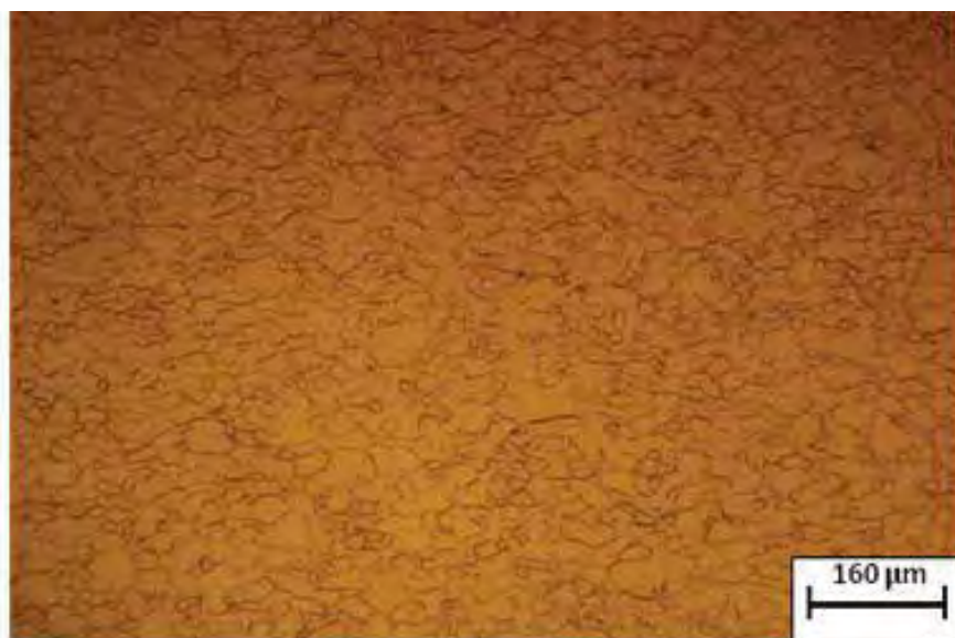
Figura 44- Fotomicrografia da amostra F (reforço central da longarina dianteira) na condição como recebido.
