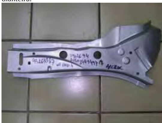
Figura 29 - Identificação de peças estampadas de material BH 180 e 210.
