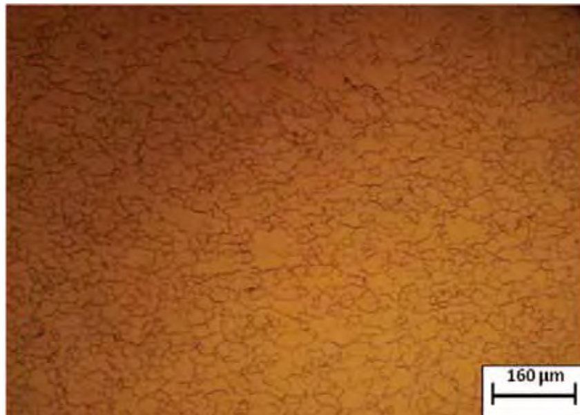
Figura 46- Fotomicrografia da amostra B (painel externo do cofre) na condição após estampagem.
