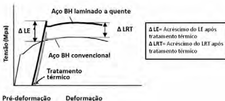
Figura 4: Ilustração esquemática do acréscimo (após tratamento térmico) do limite de escoamento e resistência a tração do aço bake hardening laminado a quente. (KANEKO; HIRAMOTO; ISHIKAWA, 2003).
