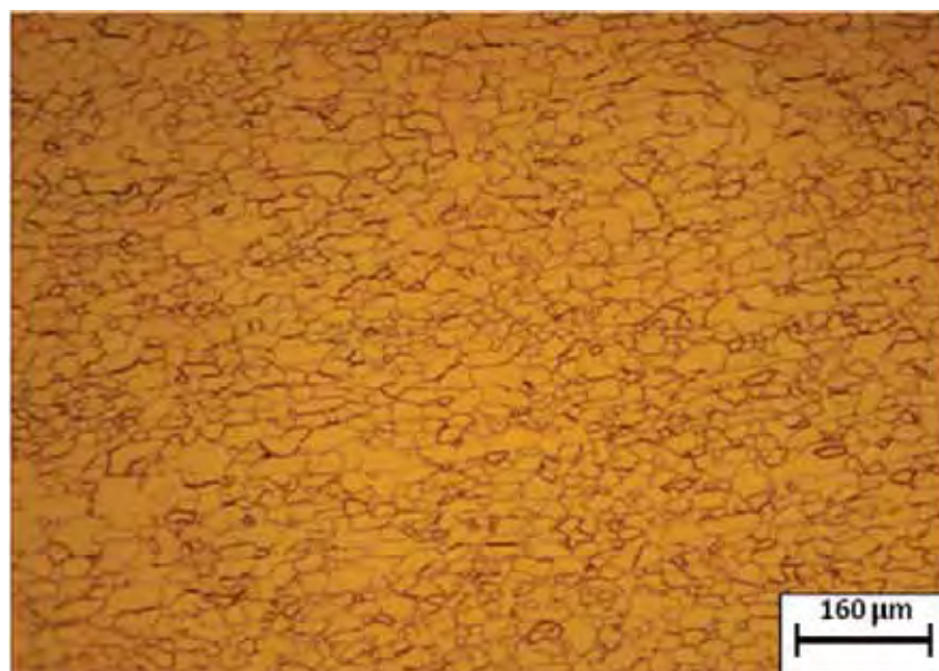
Figura 47- Fotomicrografia da amostra C (reforço central da longarina dianteira) na condição após estampagem.
